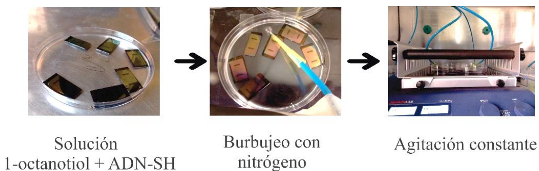
Figura 5.3. Vistas del proceso para la Inmovilización de moléculas de ADN y 1-octanotiol en nanopartículas de plata incluidas en matrices mesoporosas para la detección de la cadena complementaria luego de su hibridación.
