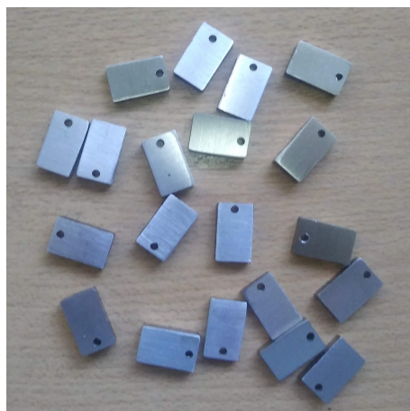
Figura 3.1: Probetas de acero inoxidable con alto contenido de inclusiones (303 SS).
