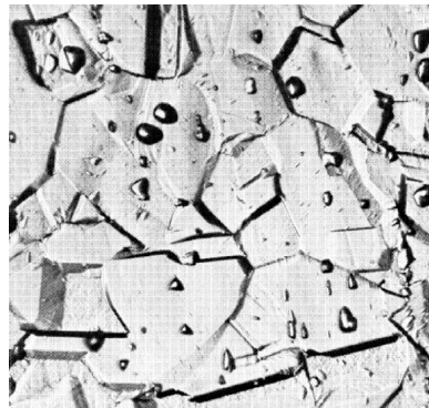
Figura 1.7: Estructura escalonada según Práctica A, observada a 500 X [21].
