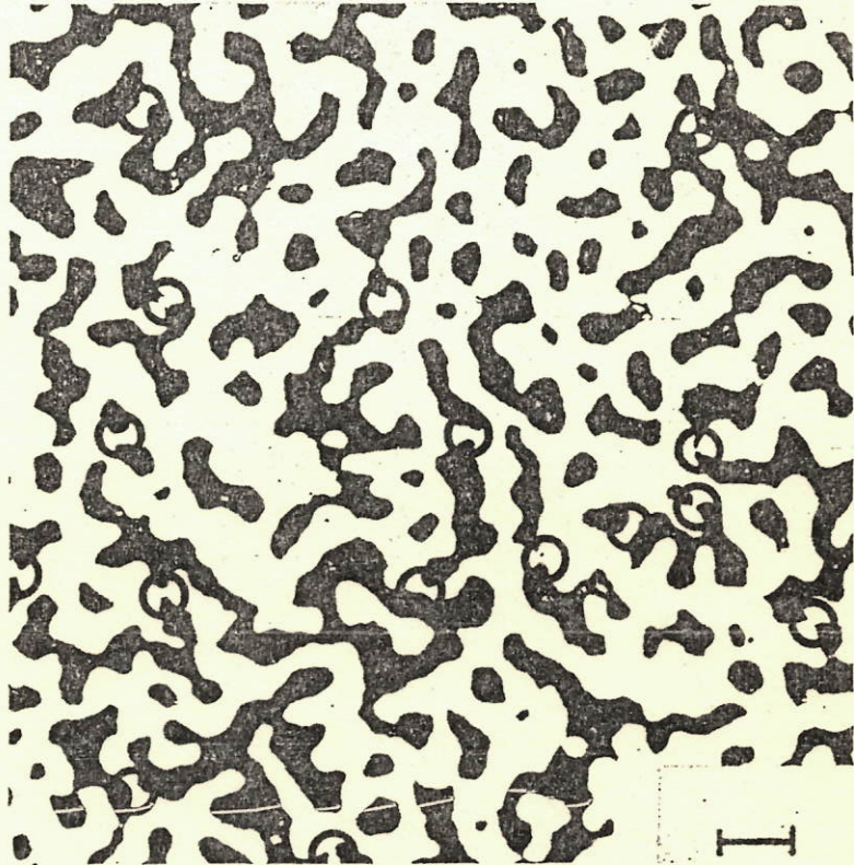
Figura 8: Micrografía de una sección pulida de Si sinterizada una hora a 1350 C en Ar. Se observan algunos cuellos que conectan la fase sólida.
