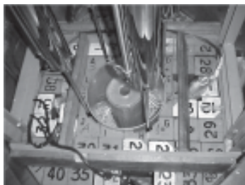
Núcleo del reactor de investigación RA-4 Universidad Nacional de Córdoba
