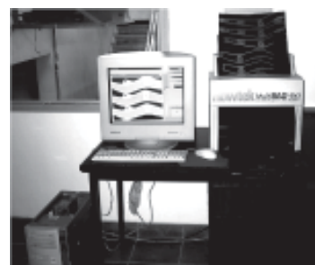
Centro Atómico Constituyentes Conservación del patrimonio cultural "Scanner" para digitalización de radiografías
