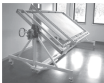
Proyecto Paneles solares Soporte giratorio con sistema de posicionamiento 3-D Centro Atómico Constituyentes
