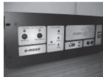
Sistemas de micro-electromecanismos (MEMs) - Prototipo de nariz electrónica para control de procesos industriales Centro Atómico Constituyentes
