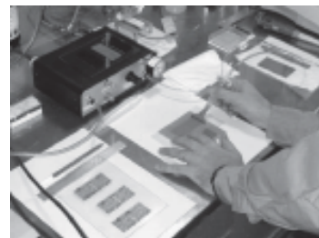
Centro Atómico Constituyentes Proyecto paneles solares Fabricación de paneles solares para satélites
