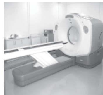
Centro de Diagnóstico Nuclear Tomógrafo por Emisión de Positrones combinado con Tomógrafo Helicoidal (PET/CT)
