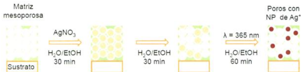
Figura 2.4: Esquema de la síntesis de NP de plata en películas mesoporosas de TiO_2
