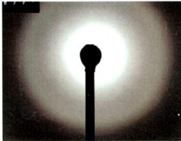
Figura 3.7: Diagrama de difracción de electrones por MET de filme de 1 capa de TiO_2 mesoporoso sintetizado aplicando TT1
