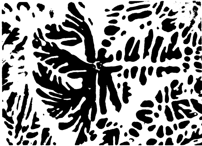
Figura 28a.- Dendrita con partícula nucleante en su origen, sobre la superficie y a media altura del lingote. Al 0.5%Ti. 720 x.
