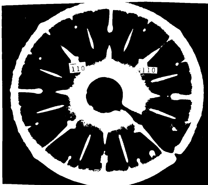
FIGURA 8 : Diagrama de difracción del eje de zona [001]_{\beta} de una muestra (011) tomado con el método de precesión de rayos-x. Nótese la ausencia de reflexiones extras.
