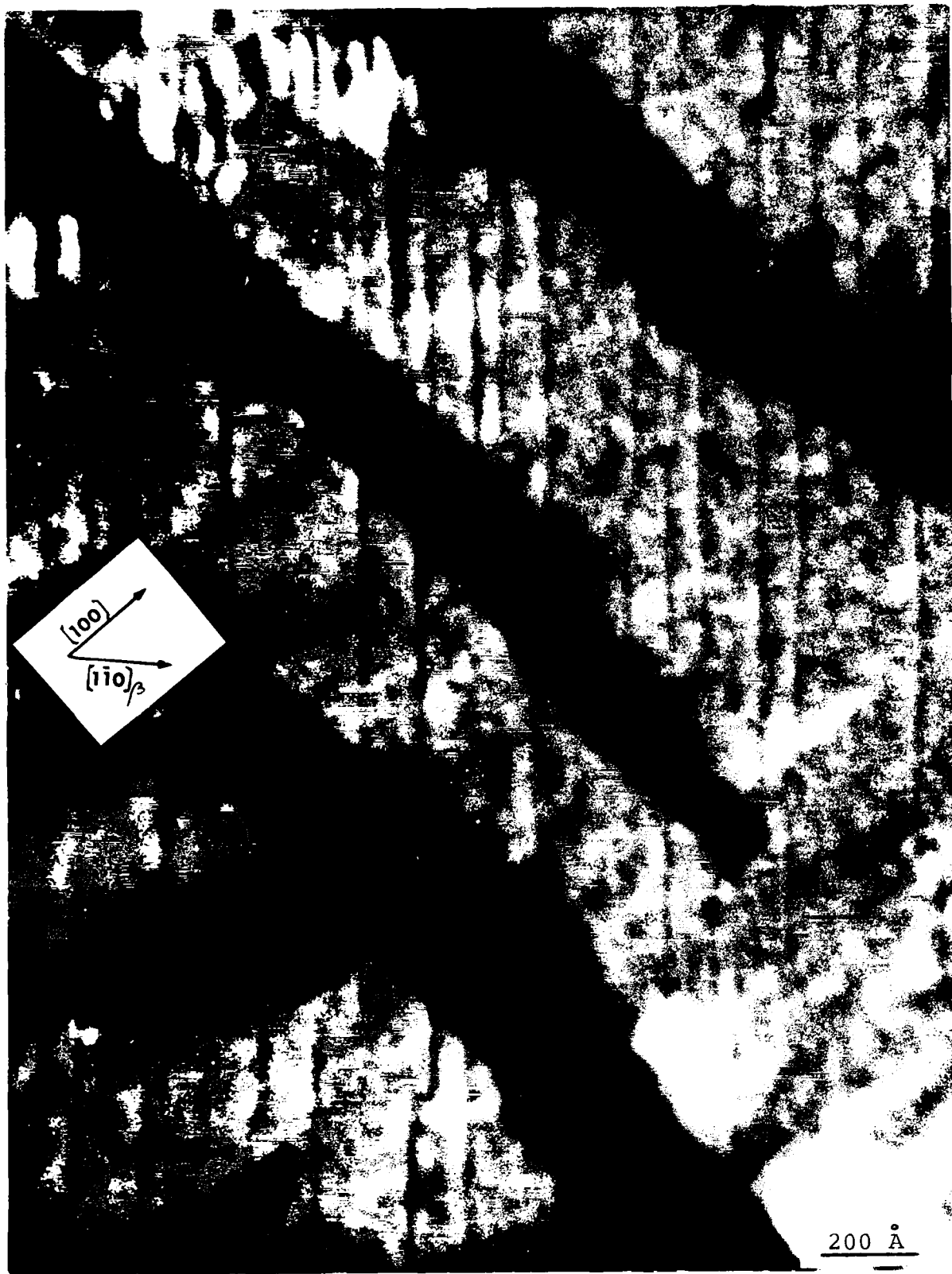
FIGURA 19: Campo oscuro tomado con la reflexión 208_{3R} de la variante 1 en la misma región de la figura 18. Nótese el contraste de las fallas internas y la interfase entre ambas variantes.
