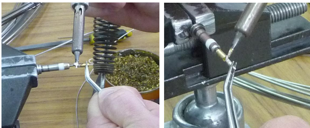
Figura 57: Soldadura del pin de acople (izquierda), y unión al pin central del BNC (derecha).
