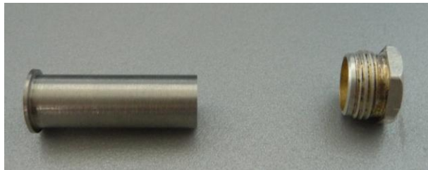
Figura 58: Dirección de colocación del buje de cierre y la tuerca de ajuste
