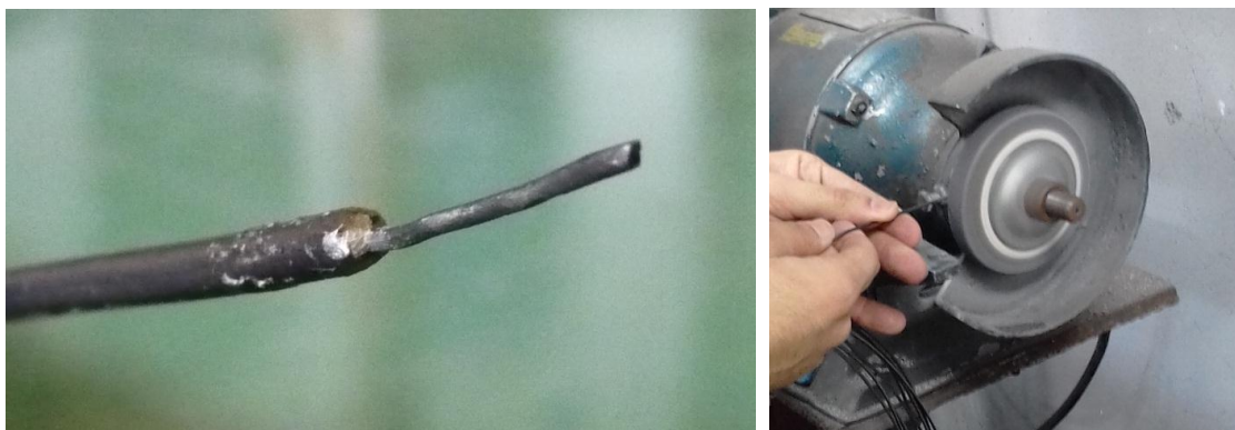
Figura 23: Pelado del cable extremo conector
