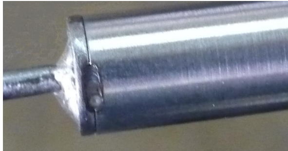
Figura 61: Detalle de la soldadura láser
