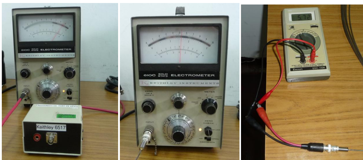
Figura 63: Constatación con la resistencia de referencia de 10^{11} Ohm (izq), medición de aislación de uno de los detectores (centro) y medición de la capacitancia (der).
