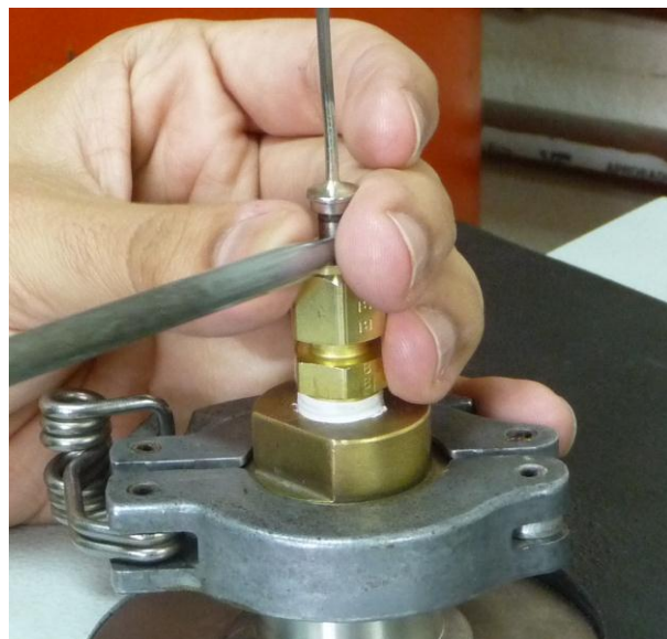
Figura 42: Con esta prueba de estanqueidad al helio se verifican las 3 soldaduras realizadas
