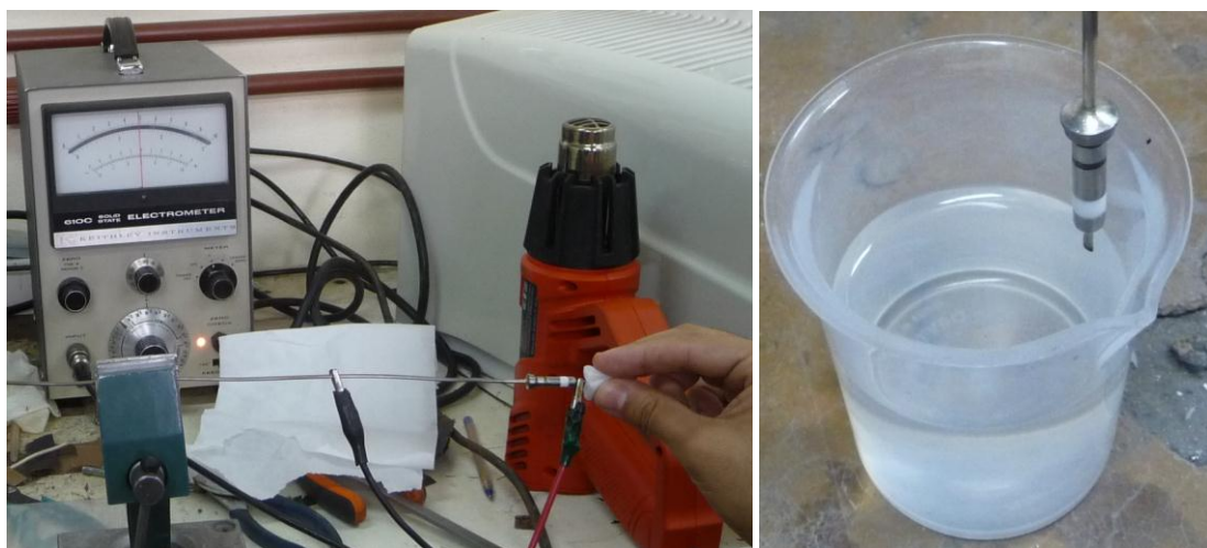
Figura 56: Ensayos para probar la estanqueidad por el método de alta humedad
