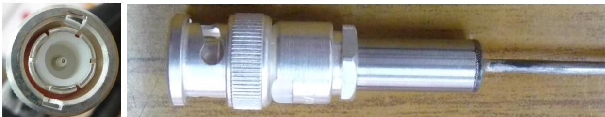
Figura 60: Vista frontal del conector (izquierda), conector BNC unido al resto del conector (derecha)
