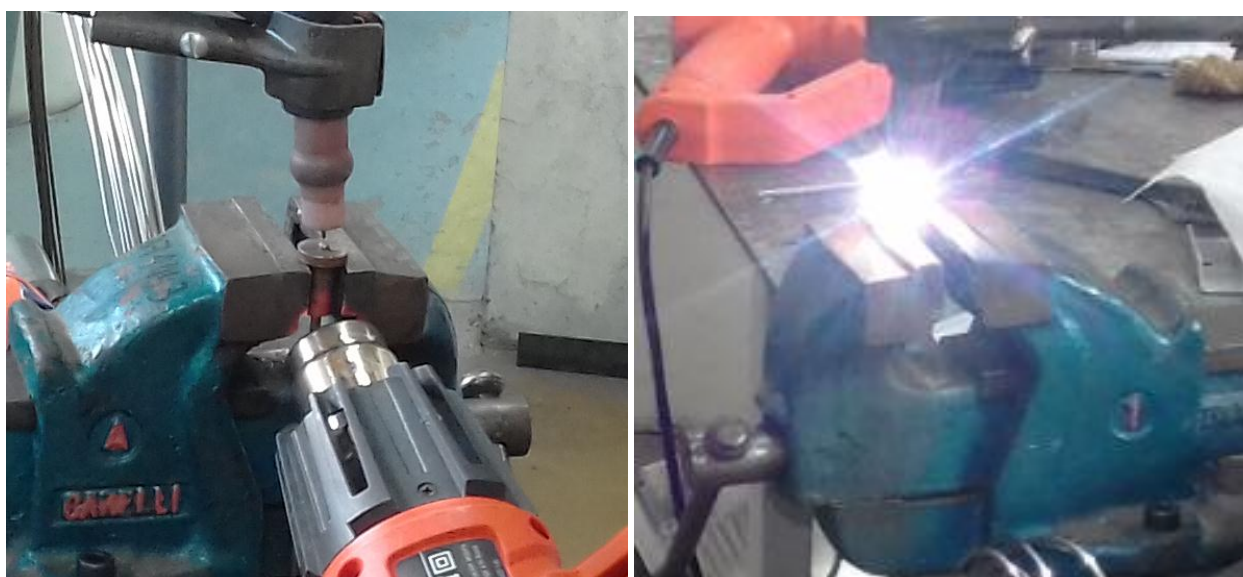
Figura 32: Calentamiento previo e instante de la soldadura del tapón
