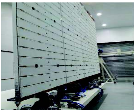
Figura 19. Modelo Estructural de la Antena SAR en CNEA
