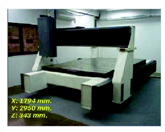
Figura 14. Izquierda: Fresadora para el mecanizado de paneles. Derecha: Equipo CNC para la fabricación de piezas metálicas
