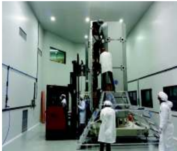
Figura 18. Integración en CNEA del Modelo Estructural de la Antena SAR
