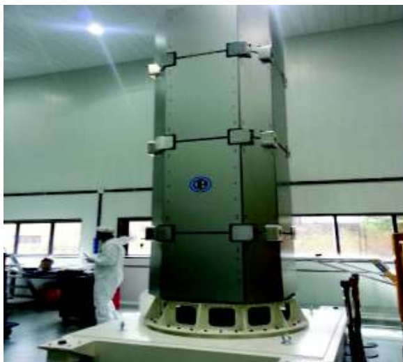
Figura 18. Integración en CNEA del Modelo Estructural de la Antena SAR
