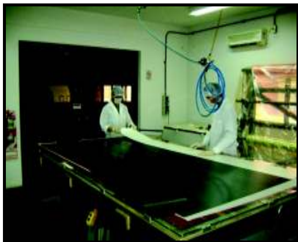
Figura 13. Elaboración de laminados de fibra de carbono y autoclave para el proceso de polimerización
