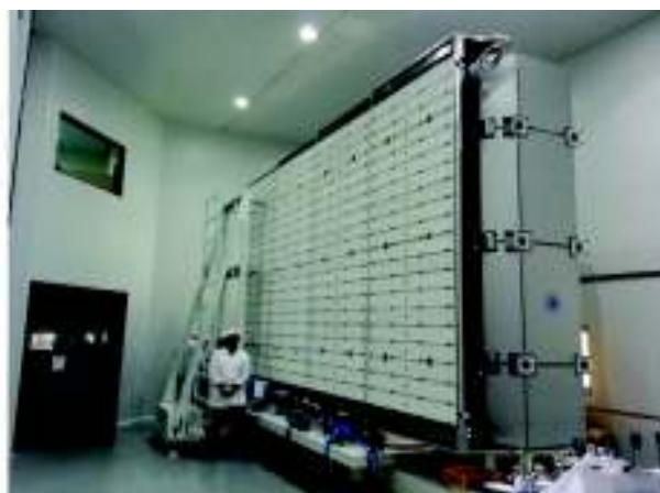
Figura 19. Modelo Estructural de la Antena SAR en CNEA
