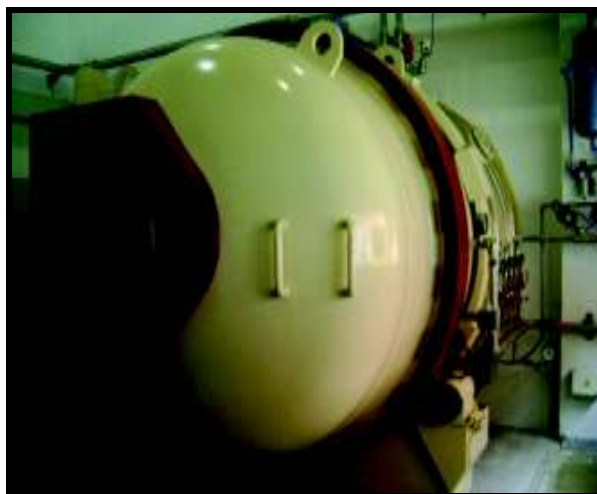
Figura 13. Elaboración de laminados de fibra de carbono y autoclave para el proceso de polimerización
