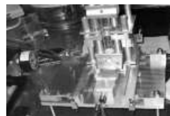
Proyecto Paneles solares Dispositivo para pegado del vidrio protector a la cara frontal de la celda solar Centro Atómico Constituyentes
