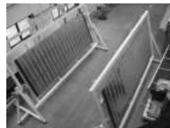
Proyecto Antena Radar de Apertura Sintética Módulos para ensayos de caracterización de radio frecuencia
