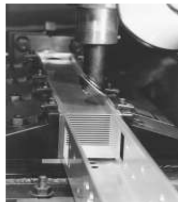
Detalle de la fabricación de la estructura soporte de aluminio para elementos combustibles tipo MTR para el reactor de investigación RA-3
