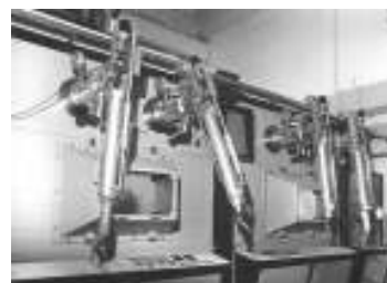
Planta de Producción de Molibdeno-99 Celdas blindadas con telemanipuladores Centro Atómico Ezeiza - Pcia. de Buenos Aires
