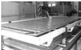
Proyecto Antena Radar de Apertura Sintética Modelos para ensayos de caracterización de radio frecuencia Centro Atómico Constituyentes Pcia. de Buenos Aires
