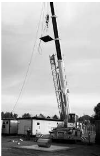
Posicionado del contenedor prototipo DALMA 25 para el ensayo de aplastamiento dinámico con una placa maciza de acero de 500 kg que cae libremente desde 9 m
