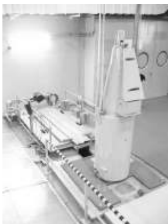
Contenedor blindado de transferencia de combustibles tipo MTR
