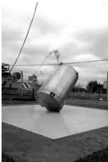
Contenedor prototipo DALMA 25 en el momento del impacto en caída libre desde 9 m con inclinación de 50° sobre la tapa
