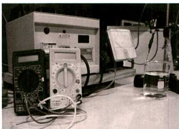
Figura III.5. Fotografía de la fuente de cc y la celda electrolítica para realizar la oxidación anódica.
