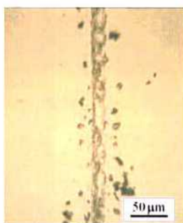
Figura IX.11. Ejemplo de fragmentos de desgaste del sustrato ( debris ).
