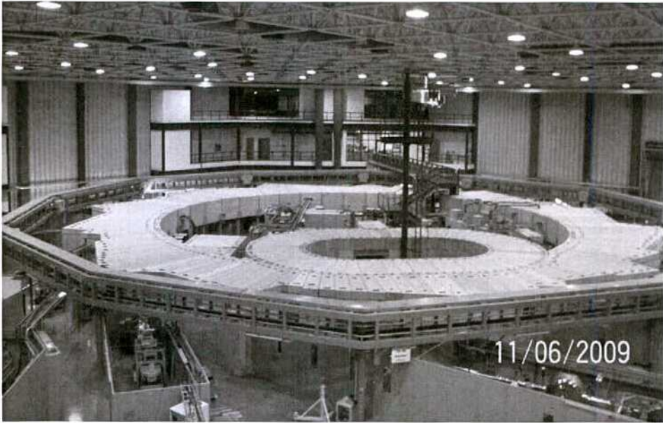
Figura III.9. Fotografía del anillo central de aceleración de electrones del LNLS.
