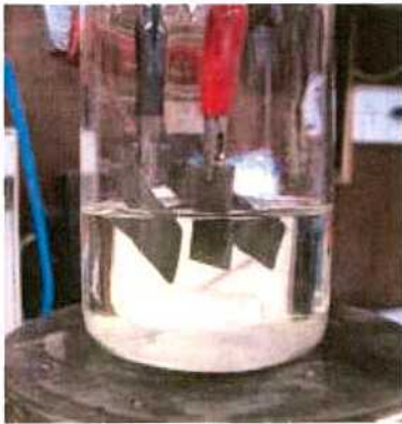
Figura ii.1. Disposición de la celda electrolítica para realizar el electropulido.
