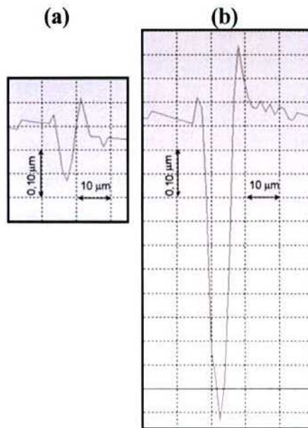
Figura IX.8. Perfiles de escaras de desgaste en la probeta SI-V40-T500 , correspondientes a diferentes condiciones de ensayo: a) 3 gr, 60 s (no rompió); b) 4 gr, 60 s (rompió).
