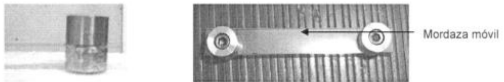
Fig.II.4.2 : en la fotografía de la izquierda se observa en detalle la mordaza y a la derecha se puede ver la probeta con las mordazas colocadas.
