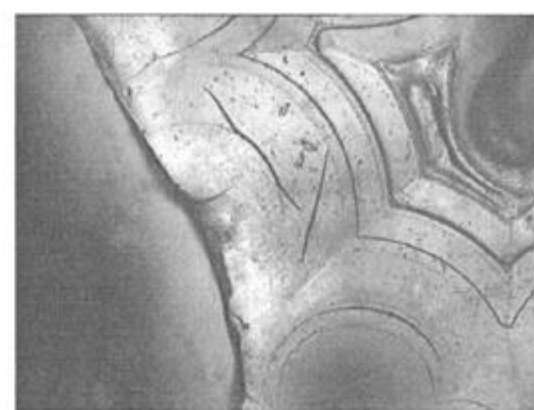
Fig.III.4.1: Micrografías ópticas de la ruptura del material por propagación de la fisura por grietas circunferenciales.
