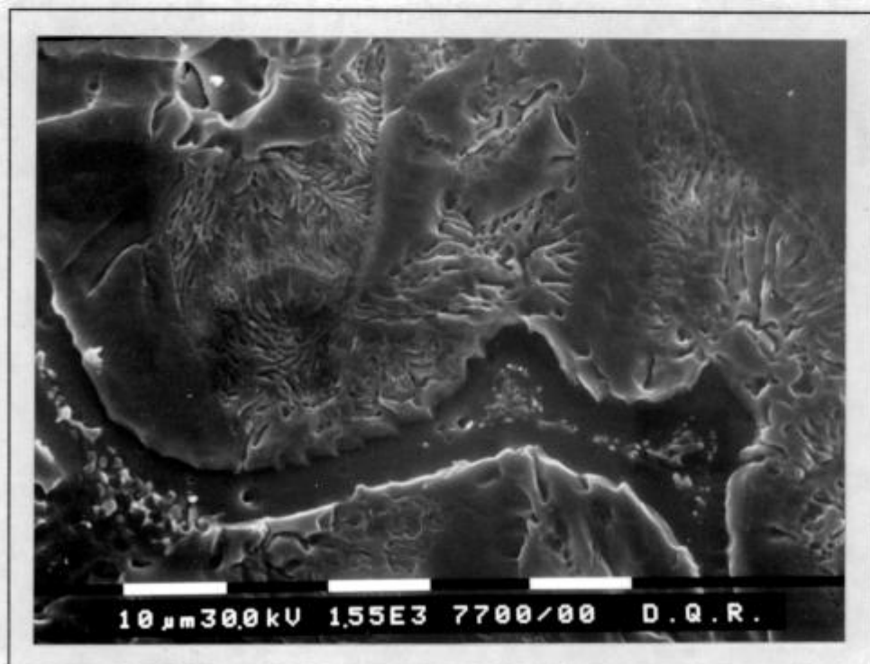
MICROG. IV-11: Con un aumento de 1500X se observa en detalle una zona en bajorrelieve con pequeñas partículas.
