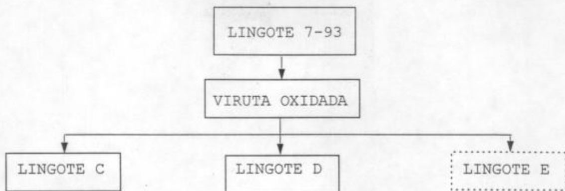
FIG. III-8: Esquema de los materiales a partir de los cuales se fundieron los los lingotes C y D.
