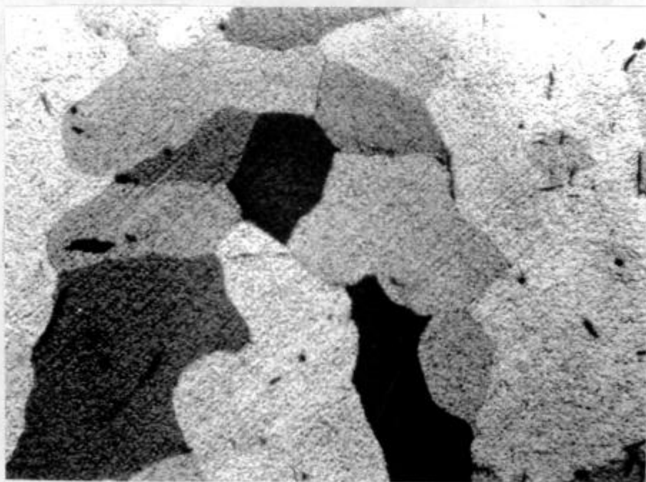
MICROG. V-2: Estructura del material 4 luego del enfriamiento en horno. Luz polarizada. Magnificación 130X.
