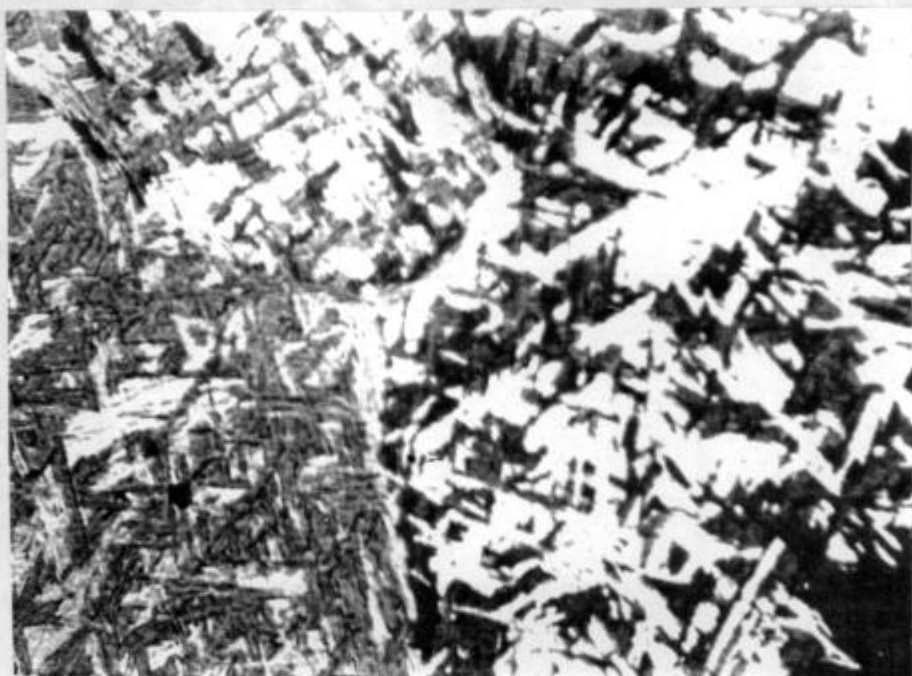
MICROG. V-1: Estructura del material 1 luego del templado en agua. Luz polarizada. Magnificación en micrografía 130X.
