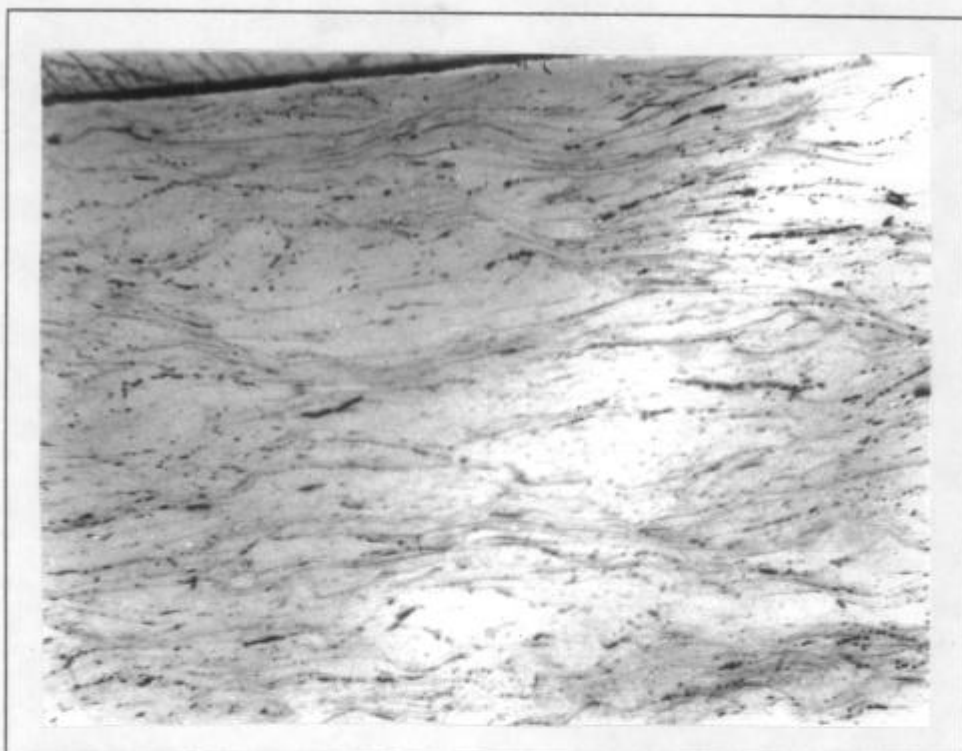
MICROG. V-9: Precipitados en el material 4 luego de la laminación en frío. Corte longitudinal. Se observan precipitados en la dirección de laminación. Luz blanca. Magnificación 130X.
