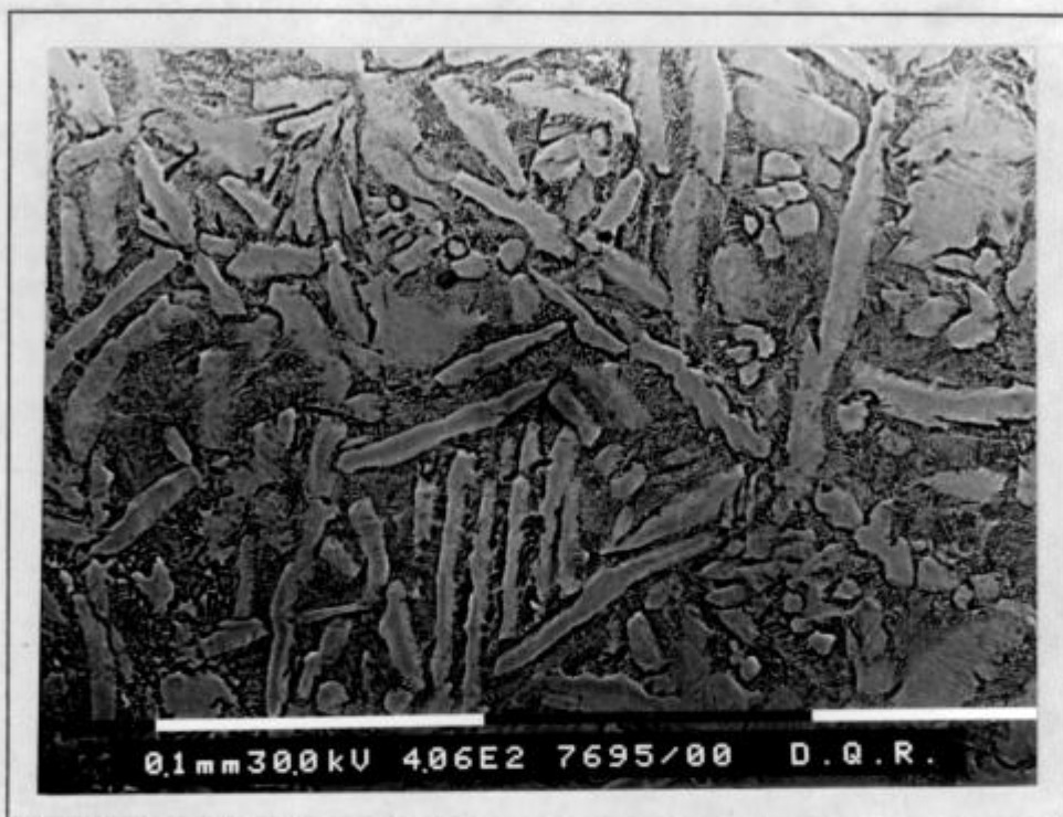
MICROG. IV-10: Probeta 3 extraída del pie de lingote. Se observan zonas en sobrerrelieve, bajorrelieve y pequeñas partículas en ésta última zona. Aumento 400X.
