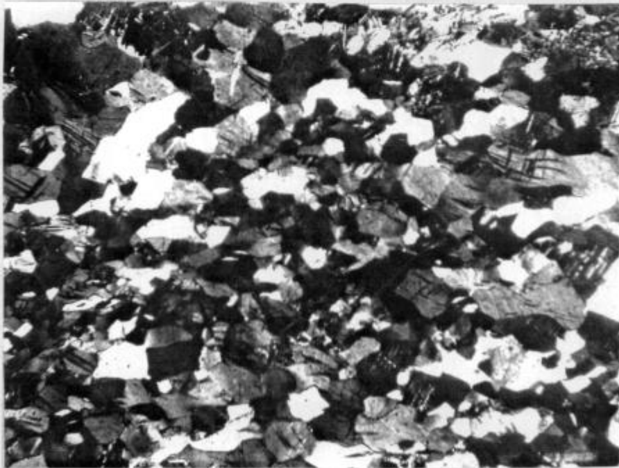
MICROG. V-5: Estructura del material 3 luego de laminado en caliente (36% de reducción en espesor) en un corte longitudinal. Luz polarizada. Magnificación 130X.
