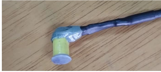
Figura 4.36. Fotografía de la bobina censora utilizada en el ensayo de RMB.
