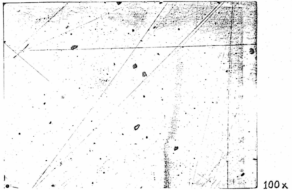
Fig. 3. Aleación de Cu N° 272. Distribución de inclusiones en la pared del tubo, en el sentido longitudinal.
