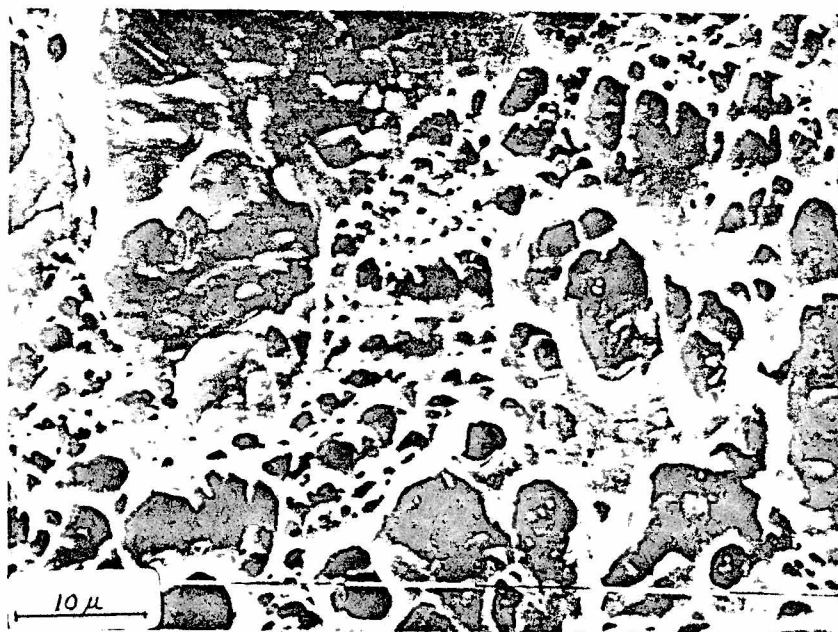
Fig. 10 . Aleación de Cu N° 270 electromicrofractografía de zona fallada durante ensayo de impacto. Fractura transgranular dúctil.
