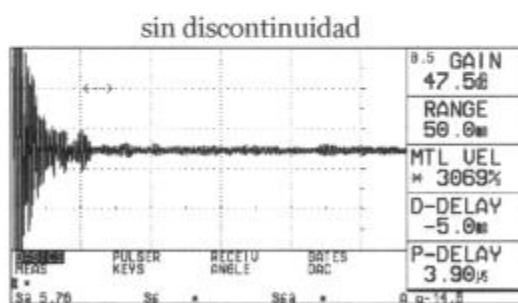
Fig. 5.9 Señal característica proveniente del lado de ranura, posición 1, técnica B, transductor MWB-45 de 4 MHz, onda transversal.
