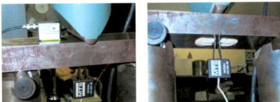
Fig. 4.13 Detalles de la colocación del transductor y del extensómetro El cual medirá la apertura de la fisura conforme aumenta la carga.
