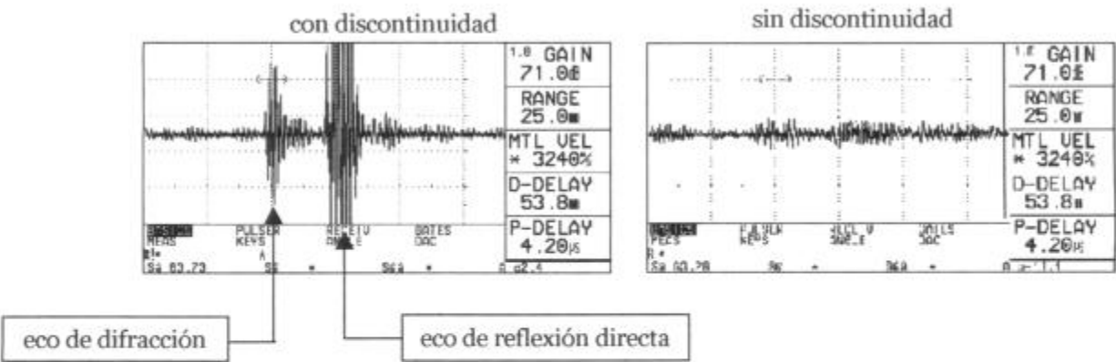
Fig. 5.3 Señal característica proveniente del lado opuesto de la ranura, técnicas A y B, transductores MWB-45 de 4 MHz, onda transversal.
