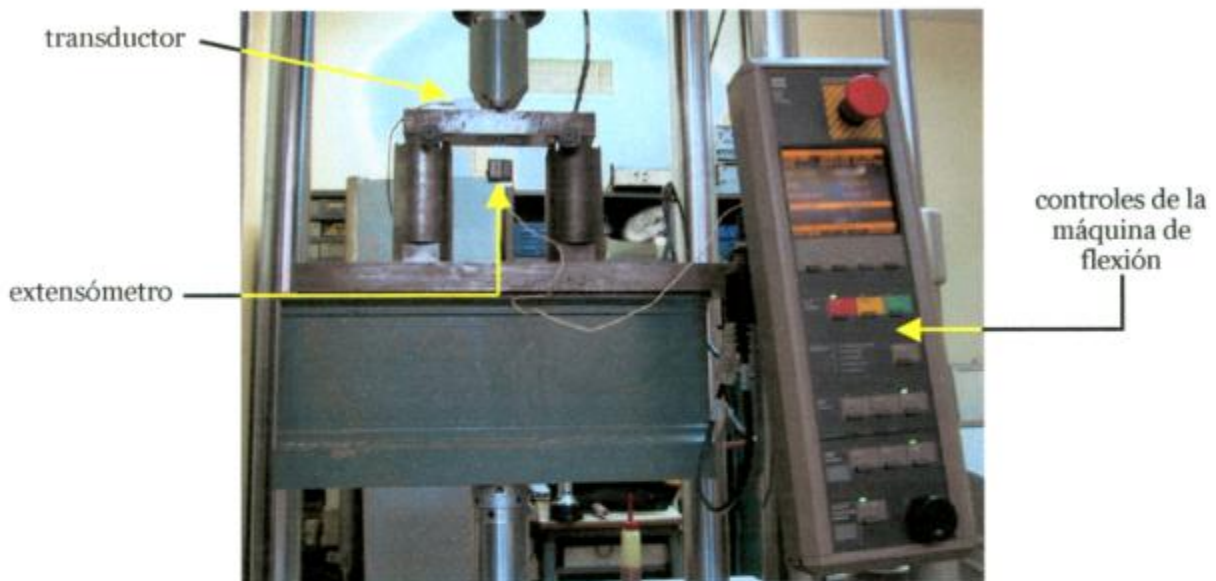
Fig. 4.12 Mecanismo de flexión en tres puntos.
