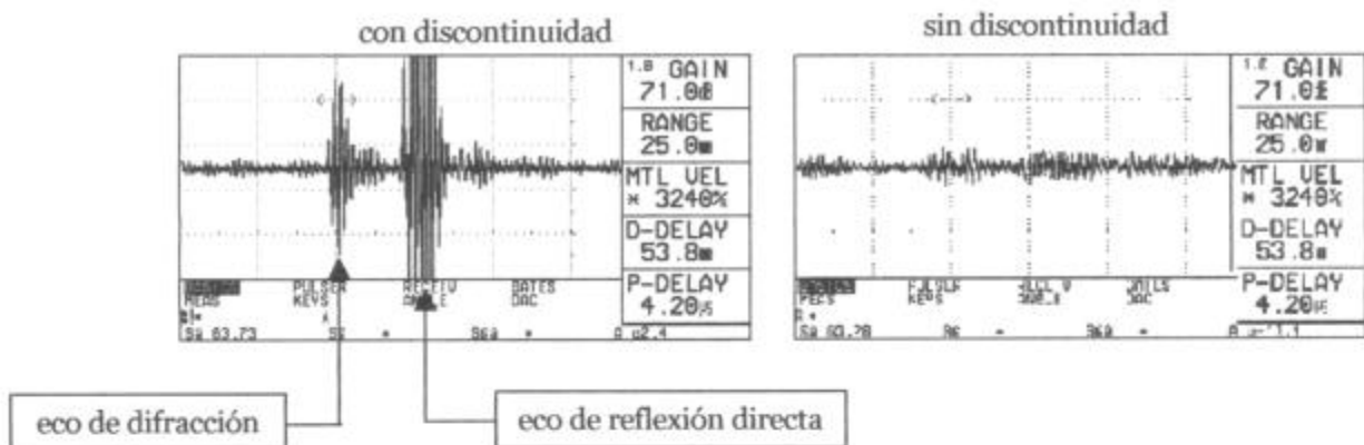
Fig. 6.1 Señal característica proveniente del lado opuesto de la ranura, técnicas A y B, transductores MWB-45 de 4 MHz, onda transversal.
