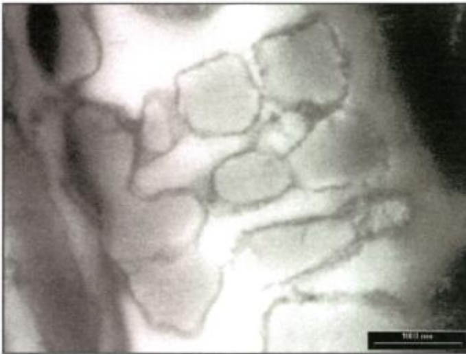
Figura 28. Micrografía electrónica de transmisión de muestra con tratamiento standard templada en agua con un tiempo de envejecimiento de 15705 horas. Nótase la unión de partículas y la partición de otras.
