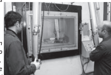
Planta de Producción de Radioisótopos Celdas blindadas con telemanipuladores Centro Atómico Ezeiza Pcia. de Buenos Aires
