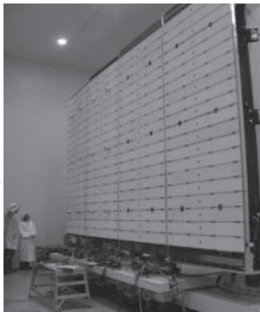
Proyecto ARAS Modelo estructural de antena completamente desplegado
