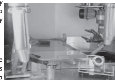
Celdas blindadas con telemanipuladores Planta de Producción de Radioisótopos
