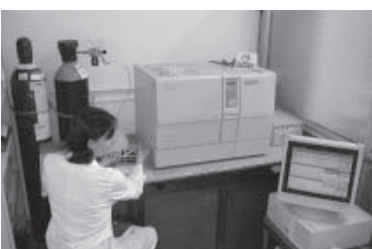
Identificación de alimentos irradiados Laboratorio de Efluentes y Productos Irradiados Cromatógrafo de masas Centro Atómico Ezeiza
