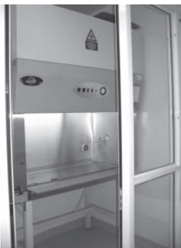
Centro de Medicina Nuclear del Hospital de Clínicas Cabina de bioseguridad Clase II para marcación de células y biomoléculas en condiciones asépticas.
