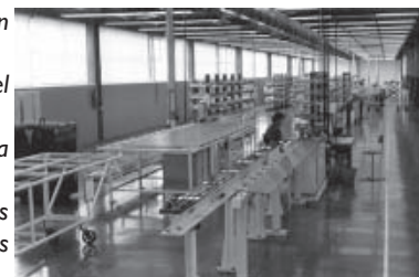
Fabricación de elementos combustibles tipo PHWR para la Central Nuclear Atucha I en CONUAR S.A.
