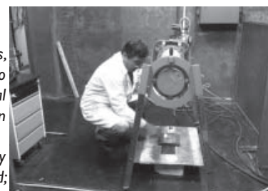
Ensayos No Destructivos Laboratorio de Radiografía Industrial Obtención de placa con equipo portátil Centro Atómico Constituyentes
