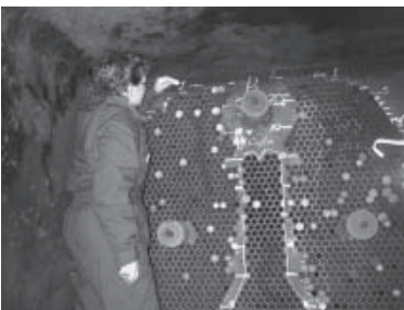
Ensayos No Destructivos Laboratorio de Corrientes Inducidas Inspección de un intercambiador de calos de central térmica Centro Atómico Constituyentes
