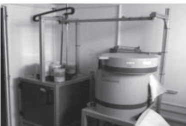
Laboratorio de Metrología de Radiosítopos Intercambiador de muestras Detector de germanio hiperpuro Centro Atómico Ezeiza
