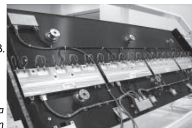
Proyecto Antena Radar de Apertura Sintética Finalización de integración de cableado al panel modelo X7-CE para su ensayo
