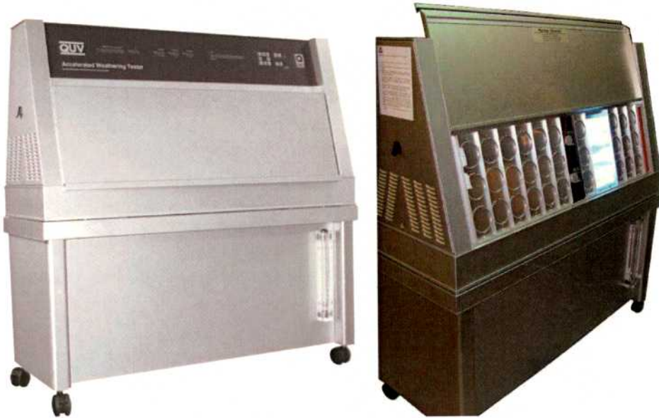
Figura II.1: Cámara Ambiental Q-Lab modelo QUV empleada en la degradación por radiación UV
