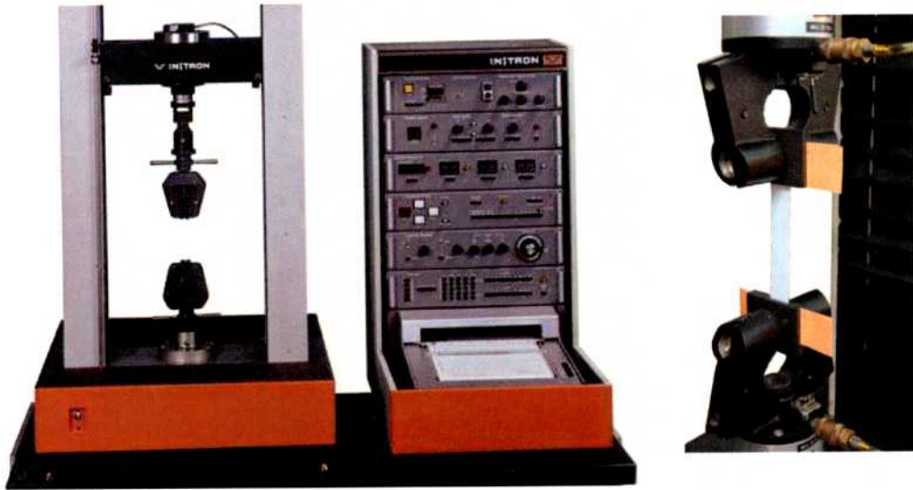
Figura II.6: Ensayo de tracción en máquina sevomecanica Instron 1122. A la derecha se observa un detalle de sujeción de la probeta mediante mordazas neumáticas.
