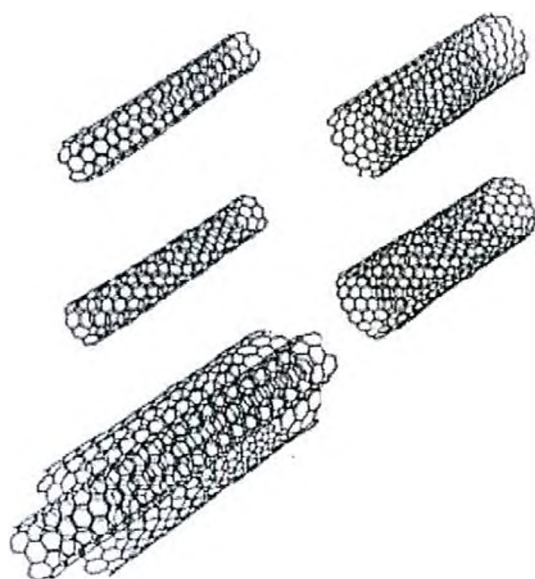
Figura 23. Nanotubos de paredes simples y múltiples.
