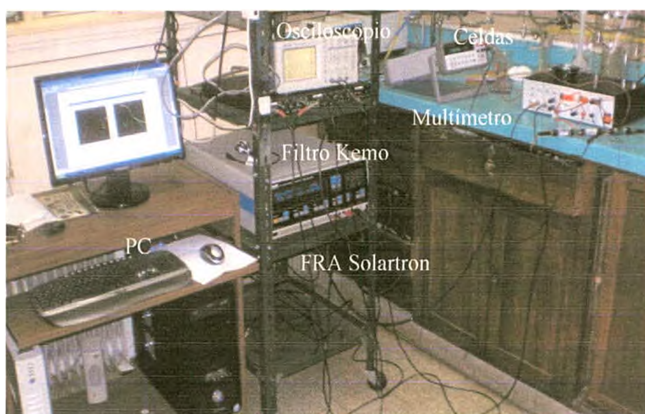
Figura 8. Conjunto de equipos agrupados para llevar a cabo las medidas de impedancia de las celdas electroquímicas.
