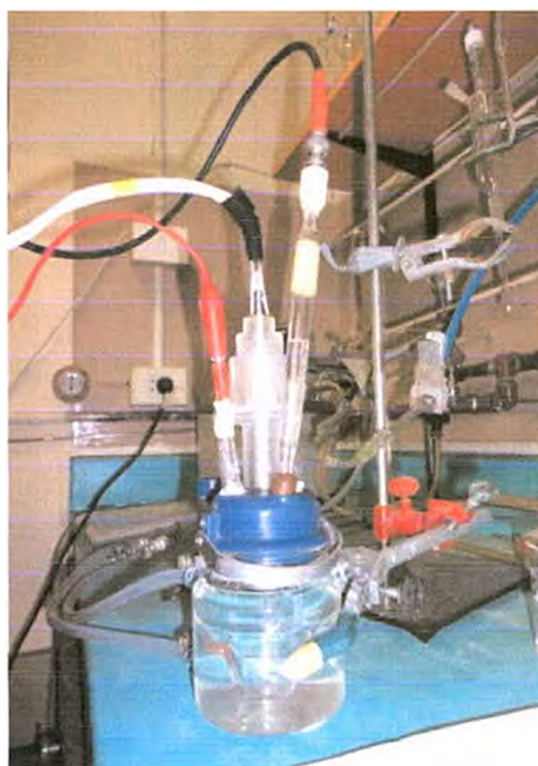
Figura 2. Fotografía de celda electroquímica con camisa termostática. En el centro, el electrodo de trabajo (WE). Cable rojo, contra electrodo (CE). Cable negro, electrodo de referencia (ER).
