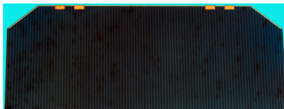
Celda solar de triple juntura del mismo tipo que las utilizadas para la integración en la CNEA de los paneles solares de las misiones SAC-D y SAOCOM-1A y 1B. (Foto Archivo CNEA)
