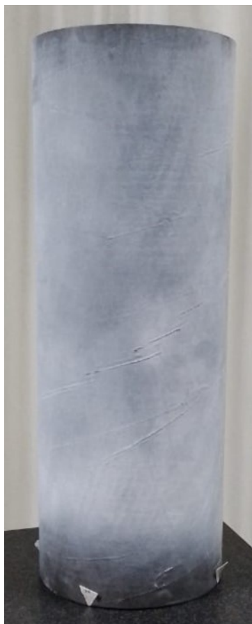
Figura 4.4. Cupón tubo bobinado de fibra de carbono.
