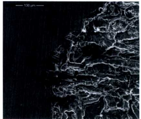
Figura 5.126 - Micrografías SEM Probeta 2507 n° 3 evaluada mediante PD-GS-PD Ensayo #4: [Cl^-] 10000 ppm / 60 °C / i_{GS} : 25 \mu A/cm^2
