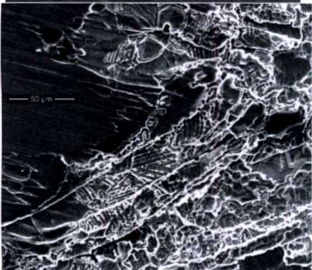
Figura 5.127 - Micrografías SEM Probeta 2507 n° 2 evaluada mediante PD-GS-PD Ensayo #5: [Cl^-] 10000 ppm / 60 °C / i_{GS} : 25 \mu A/cm^2
