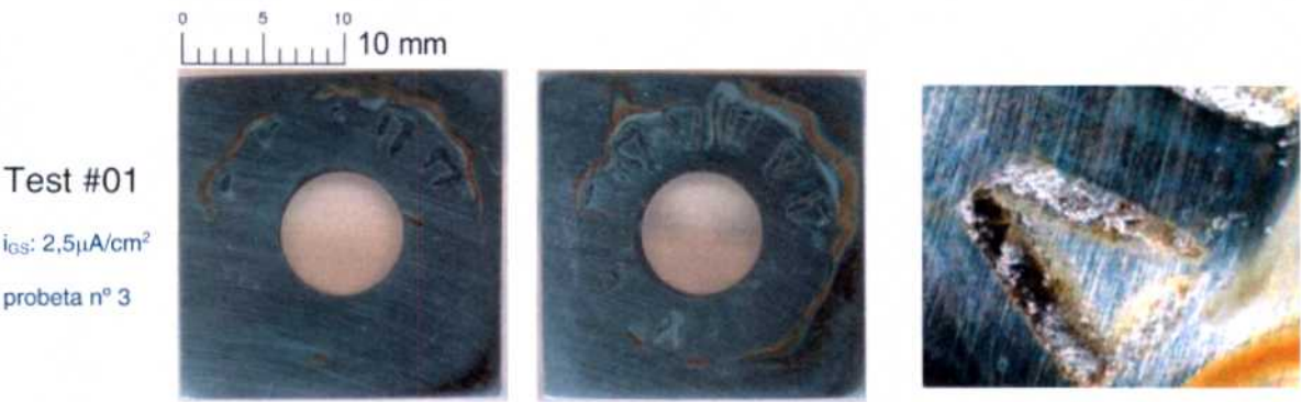
Figura 5.118 - Probeta 654SMO PCA ensayada por método PD-GS 24h -PD en solución [Cl - ] 10000 ppm y 90°C
