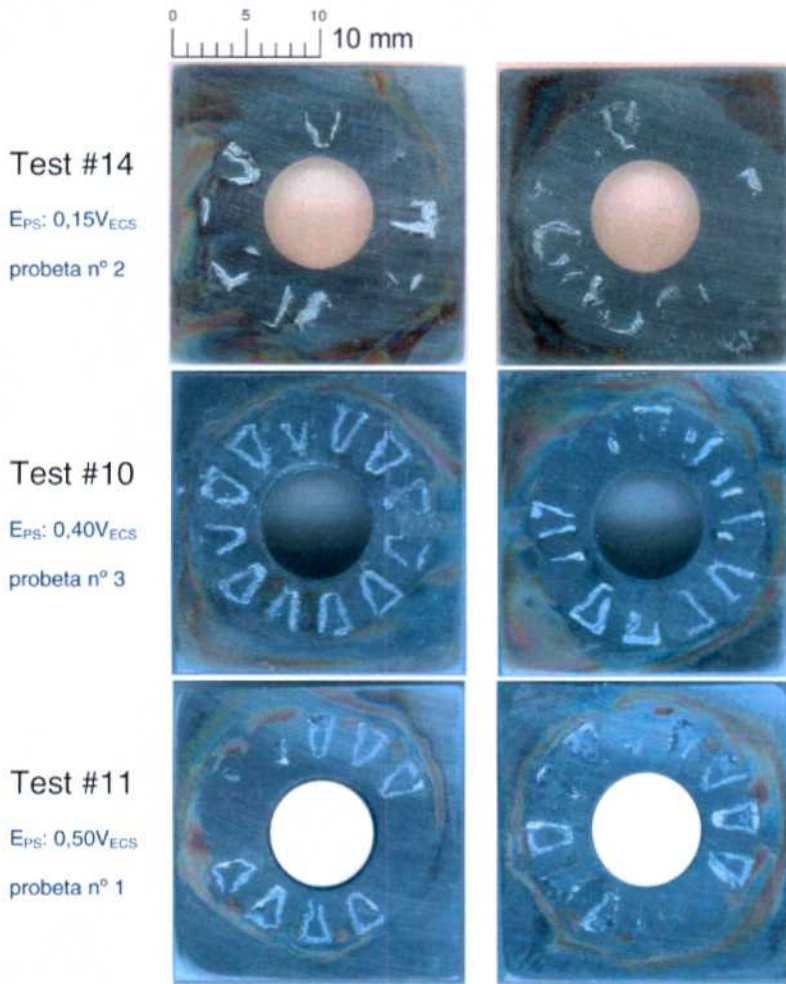
Figura 5.94 - Probetas 654SMO PCA ensayadas por método PD-PS-PD en solución [Cl^-] 100000 ppm y 60°C
