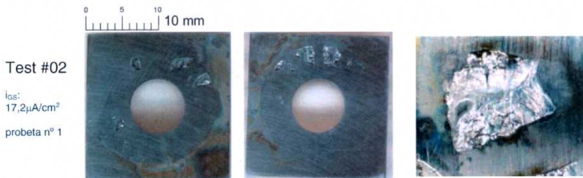
Figura 5.104 - Probeta 254SMO PCA ensayada por método PD-GS 24h -PD en solución [Cl - ] 10000 ppm y 60°C
