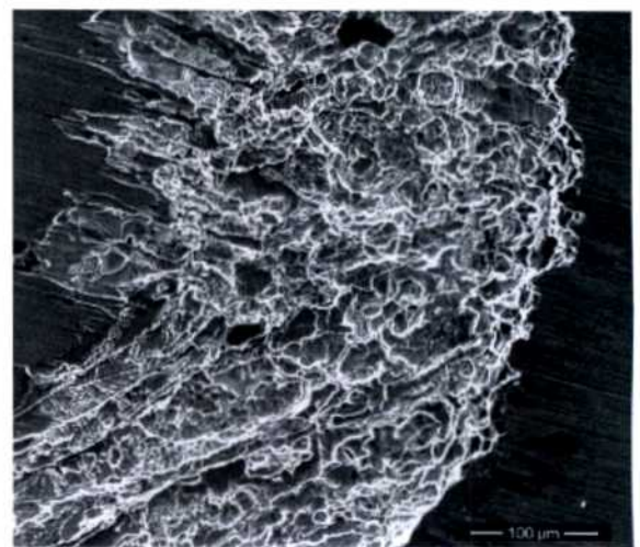
Figura 5.126 - Micrografías SEM Probeta 2507 n° 3 evaluada mediante PD-GS-PD Ensayo #4: [Cl^-] 10000 ppm / 60 °C / i_{GS} : 25 \mu A/cm^2
