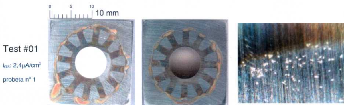
Figura 5.112 - Probeta 654SMO PCA ensayada por método PD-GS 24h -PD en solución [Cl - ] 100000 ppm y 30°C
