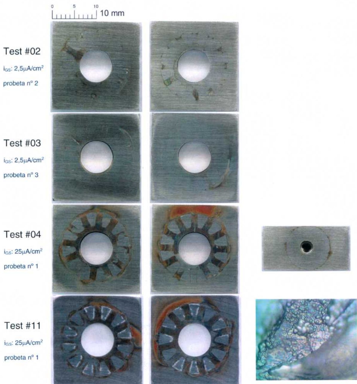
Figura 5.49 - Probetas 654SMO PCA ensayadas por método PD-GS-PD en solución [Cl - ] 10000 ppm y 60°C
