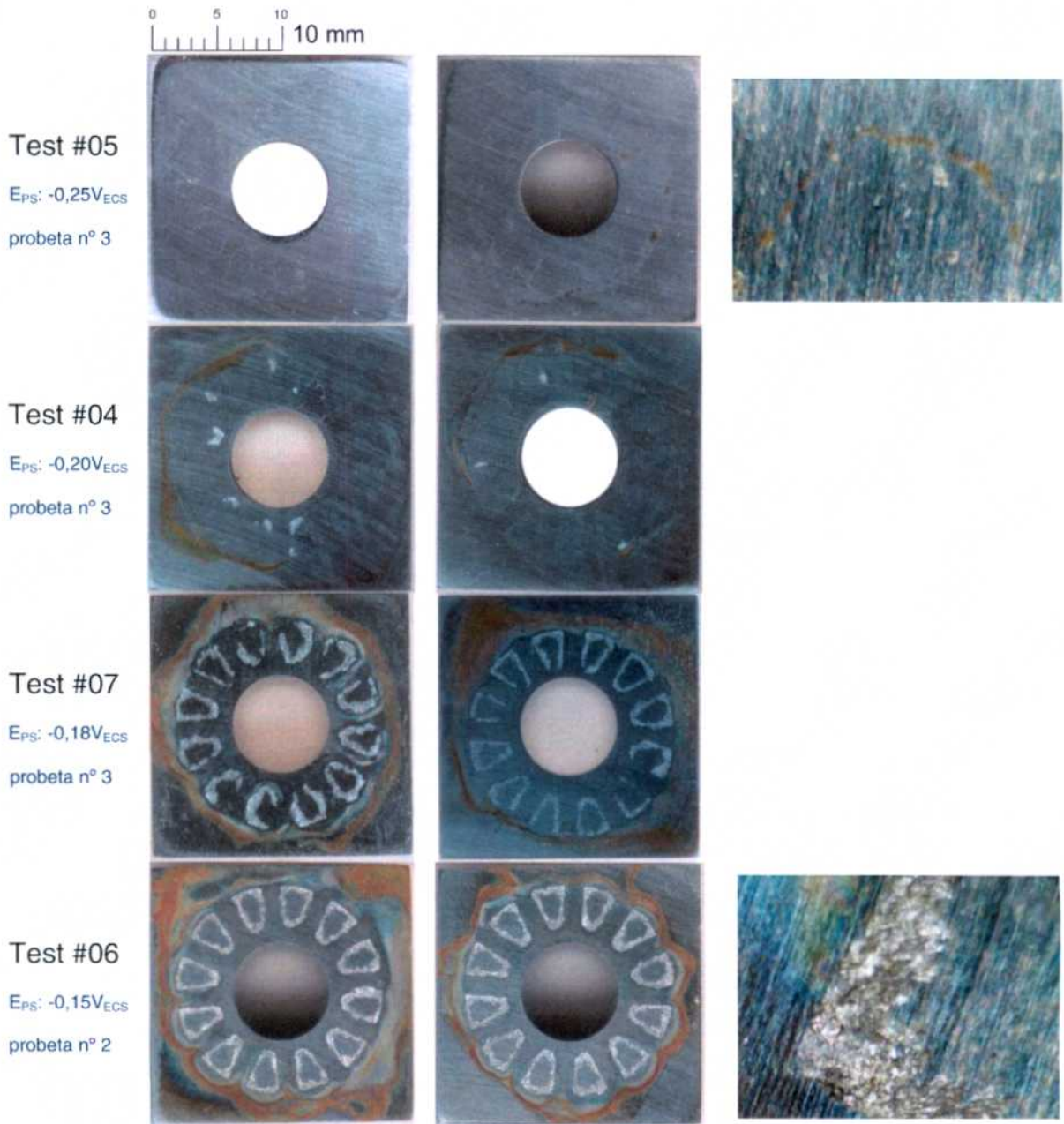
Figura 5.67 - Probetas 2507 PCA ensayadas por método PD-PS-PD en solución [Cl^-] 100000 ppm y 90°C
