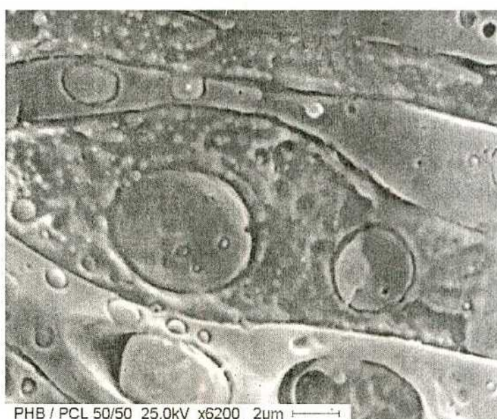
Figura 2.4: fotografías MEB de la mezcla PHB/PCL 50/50. Detalle de la estructura tipo “salame”.
