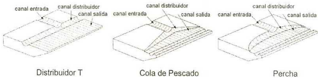
Figura 7.1: Diversos diseños de cabezal para película plana (imagen de Rauwendaal, 2001).
