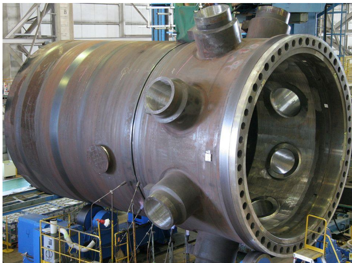
Figura I.1. Recipiente a presión para una Central Nuclear. Los espesores de las paredes habitualmente oscilan entre 25 cm y 30 cm.
