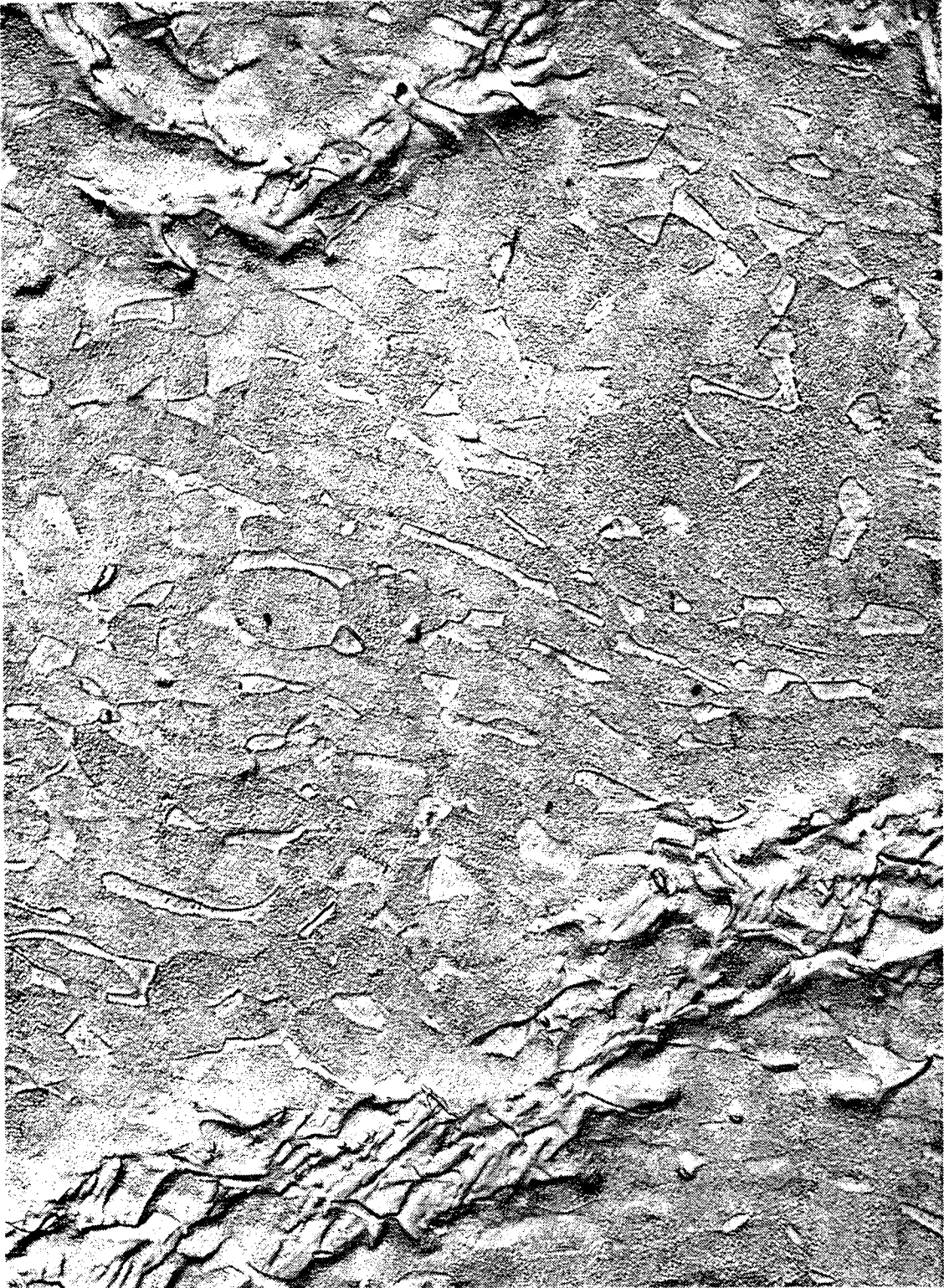
Fig. 7.10.1 Microestructura de un tubo de presión de aleación Excel Zr-3,5%Sn-0,8%Mo-0,8%Nb. El ataque metalográfico revela las fases \alpha y \beta , y los hidruros reorientados por la tensión circunferencial. Réplica de doble etapa plástica - carbono sombreado con Au Magnificación: 12400X.
