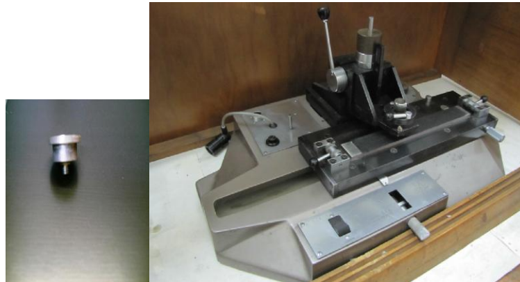
Figura 3.9. Seccionadora de caras paralelas. Permite hacer seccionados de unos pocos \mu\text{m} .
