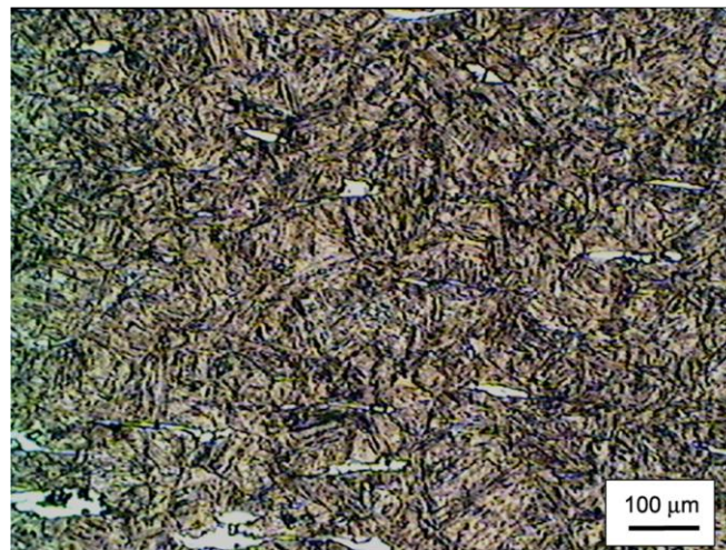
Figura 5.1. Micrografía por microscopio óptico del acero inoxidable martensítico ASTM 410.
