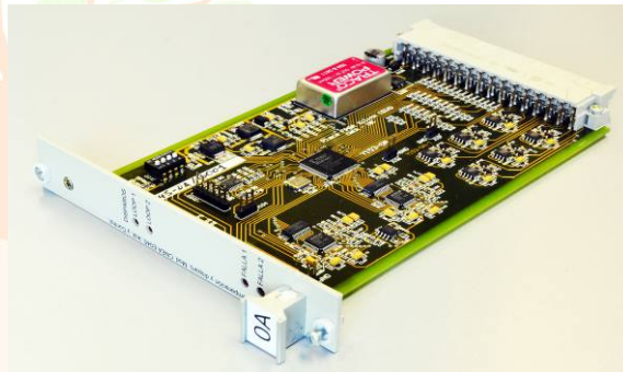
Módulo electrónico típico desarrollado para instrumentación de la Central Nuclear Atucha II.
