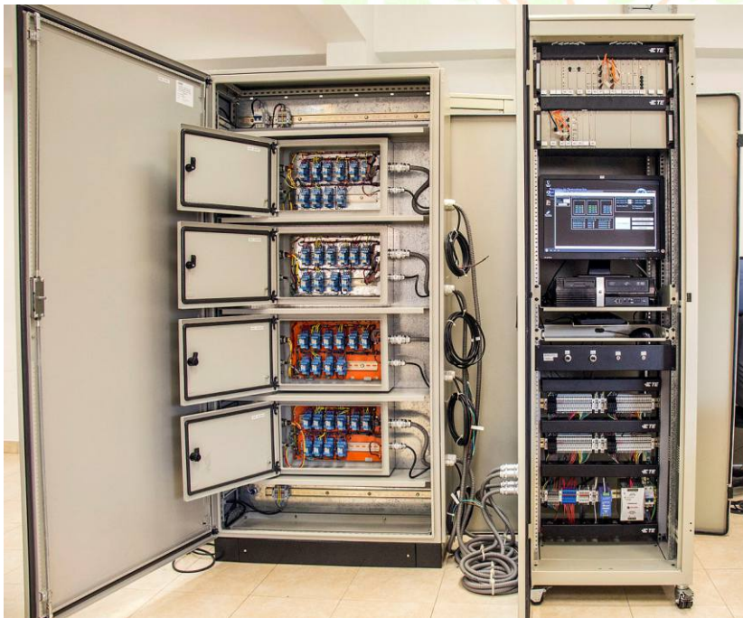
Prototipo del sistema de protección del reactor CAREM instalado para su evaluación en el Centro Atómico Bariloche.
