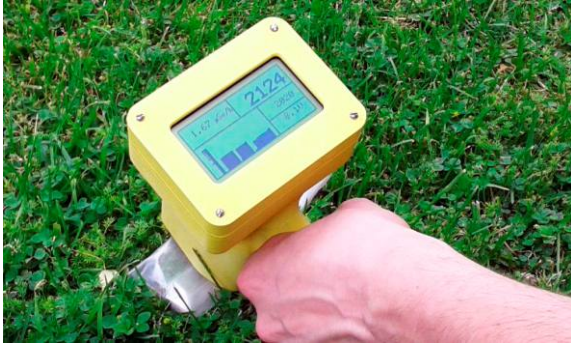
Instrumento detector portátil desarrollado para la prospección de uranio.
