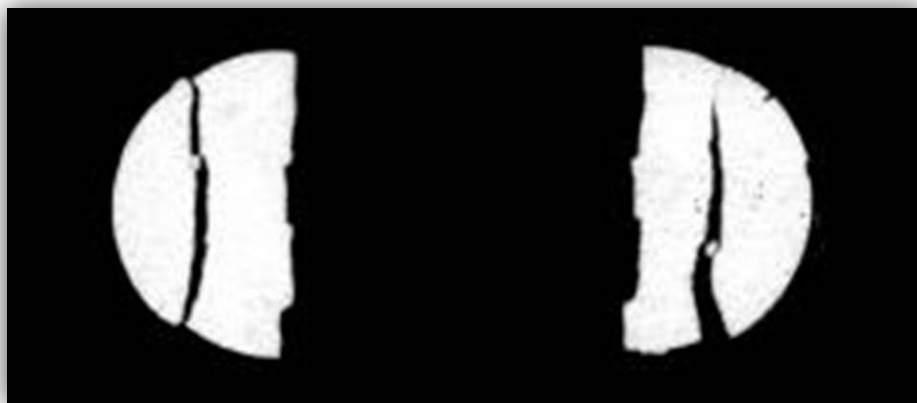
Figura 1.6 Radiografía de la rotura del núcleo monolítico de U10Mo en una placa revestida con Al 6061 después de haber sido colaminada en caliente.
