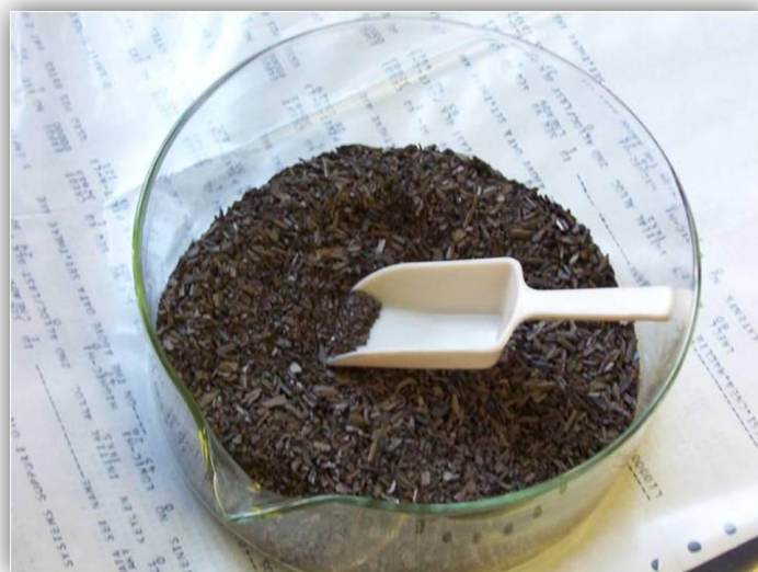
Figura 2.5 Fragmentos obtenidos después de la hidruración masiva de \gamma -U7Mo.
