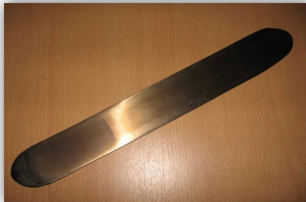
Figura 2.29 Miniplaca monolítica de \gamma -U7Mo con revestimiento de acero inoxidable.
