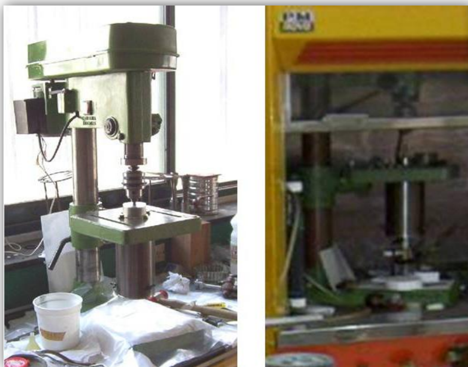
Figura 4.9 Molino cónico oscilante montado en una agujereadora vertical y en funcionamiento en la campana con filtro absoluto.
