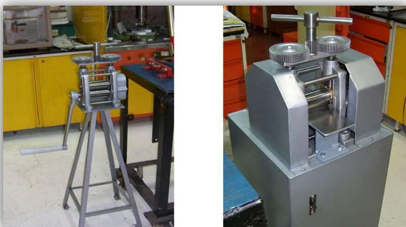
Figura 4.10 Laminadora manual para procesar UMo y su motorización posterior.
