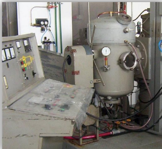
Figura 4.17 Horno de inducción en la Planta FECRI de CONUAR para fundir aleaciones de UMo.
