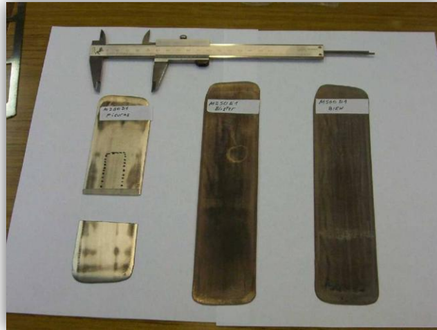
Figura 3.13 Miniplacas de \gamma -UMo/Zry-4 de prueba
