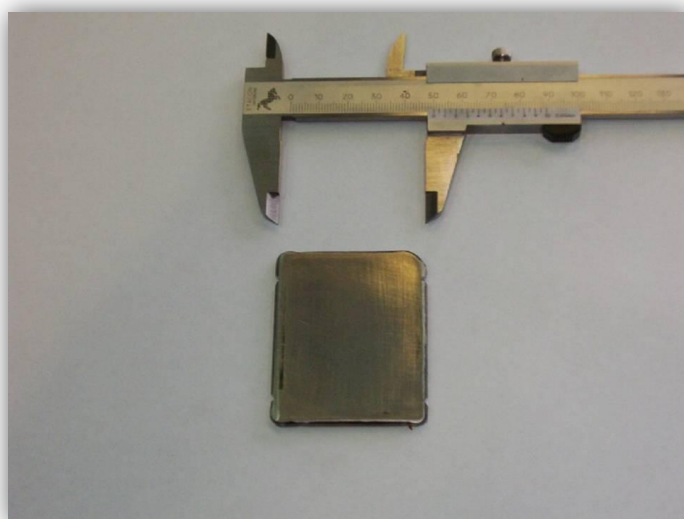
Figura 3.11 Conjunto de marco y tapas soldados lateralmente por TIG de miniplaca monolítica de \gamma -U7Mo/Zry-4.
