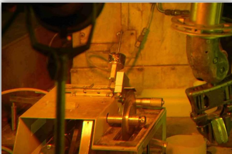
Figura 3.26 Cortado de la miniplaca MZ25 en la celda caliente.
