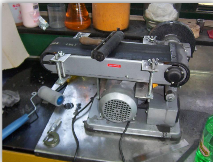
Figura 4.13 Lijadora con banda invertida y mordazas para el pulido de miniplacas con revestimiento de Zry-4.
