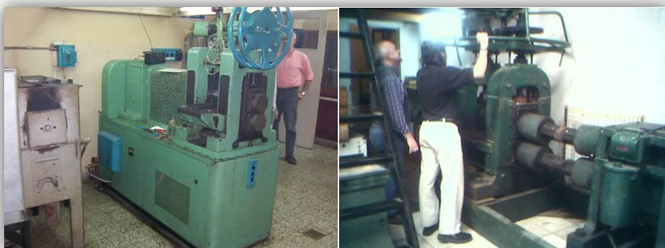
Figura 4.11 Laminadoras utilizadas para laminar miniplacas de UMo disperso y monolítico.
