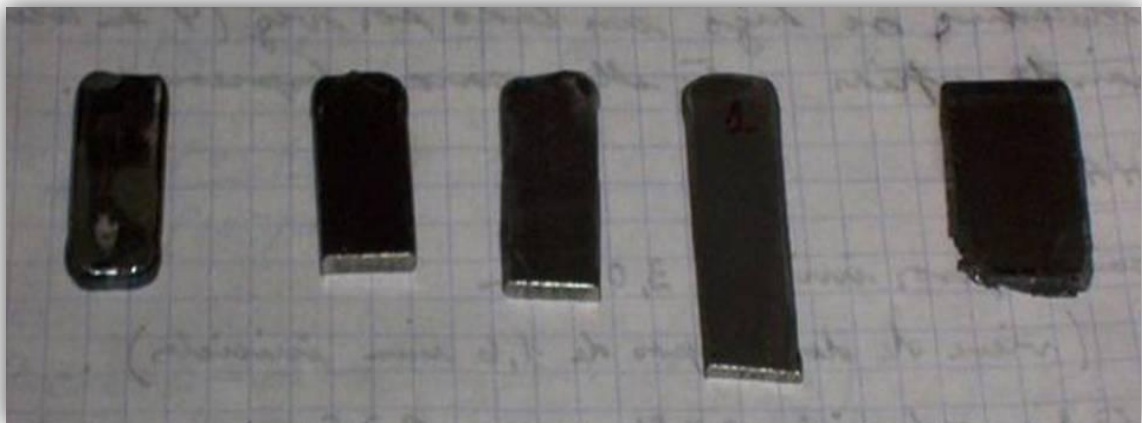
Figura 3.2 Placas apiladas, soldadas lateralmente y colaminadas de Zry-4.
