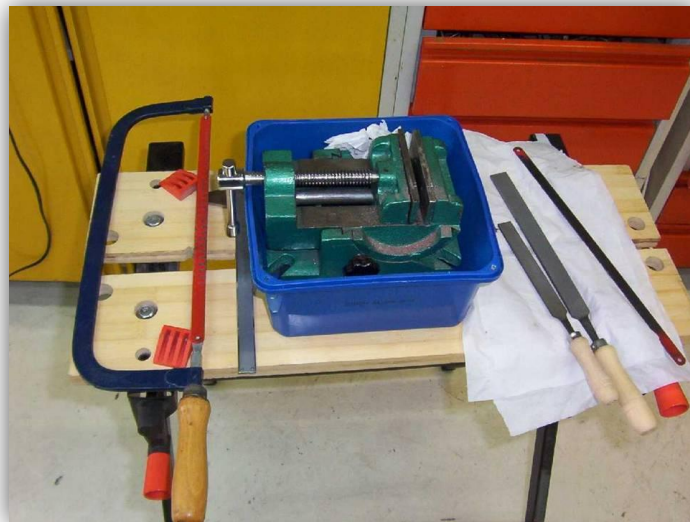
Figura 3.5 Herramientas manuales para conformar el núcleo de \gamma\text{-U7Mo} .
