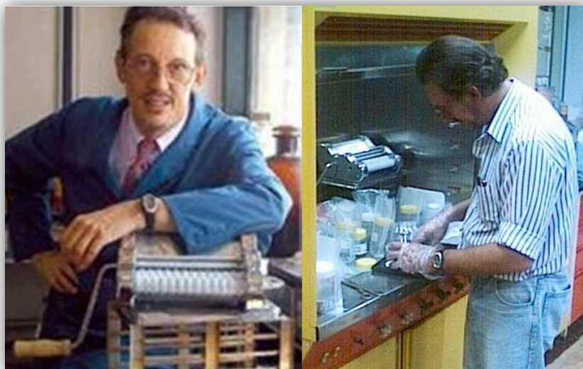
Figura 4.7 En ambas fotos se muestra la Pastalinda® con rodillos de acero cementado utilizada para la primera reducción de tamaño del hidruro de \gamma -U7Mo (ver siguiente título).
