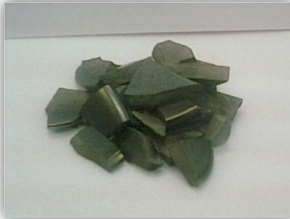
Figura 2.1 Trozos de 50 g de uranio molibdeno de 8 milímetros de espesor listos para ser hidrurados en una atmósfera de hidrógeno a baja temperatura.
