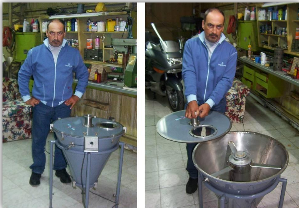
Figura 4.14 Gustavo Labala, especialista en altas revoluciones, junto a la cámara de atomización centrífuga ciclónica.
