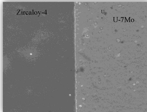
Figura 3.3 Interfase soldada entre U7Mo y Zry-4. Metalografía óptica, 1000 x.
