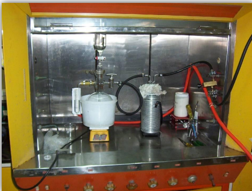
Figura 2.21 Reactor refrigerado para la producción de silano y filtro de hielo seco. El tubo rojo está conectado a la cámara donde se recubre el polvo de UMo.
