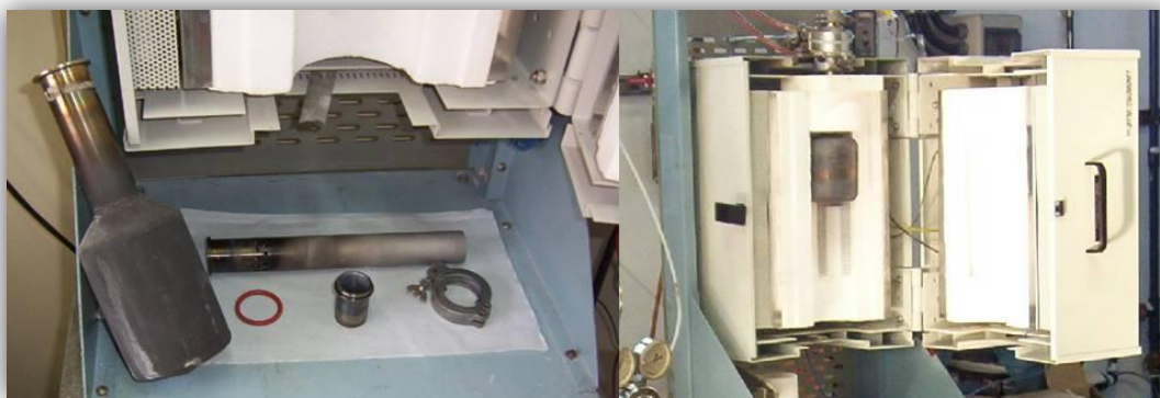
Figura 4.4 Cámara de AISI 310 para hidrurar trozos de UMo y, deshidrurar y recubrir polvos, afuera (izquierda) y posicionada (derecha) en el horno eléctrico.
