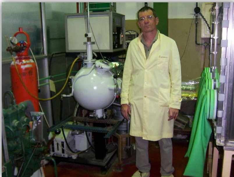
Figura 4.15 Gustavo Rossi, encargado de la fundición de aleaciones de uranio en la Planta ECRI en el Centro Atómico Constituyentes, junto al horno de inducción.
