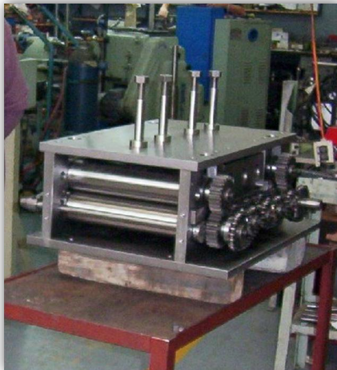
Figura 4.12 Enderezadora de placas con rodillos de 50 mm de diámetro.
