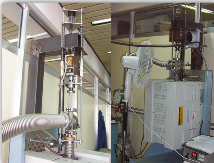
Figura 4.5 Sistema vibrante y de refrigeración de la cámara de tratamientos térmicos de polvos.
