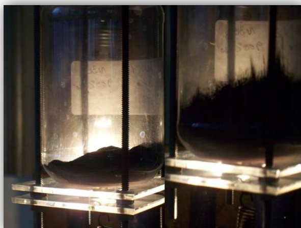
Figura 4.3 El polvo de WC quieto (izquierda) es fuertemente agitado (derecha) con un rápido movimiento ascendente impartido por un electroimán en frascos de 0,5 l de volumen.
