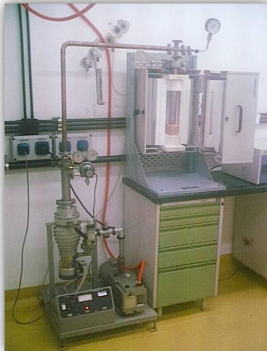
Figura 4.2 Horno eléctrico, equipo de vacío, refrigeración y control de gases utilizado para hidrurar y deshidrurar masivamente aleaciones de UMo.
