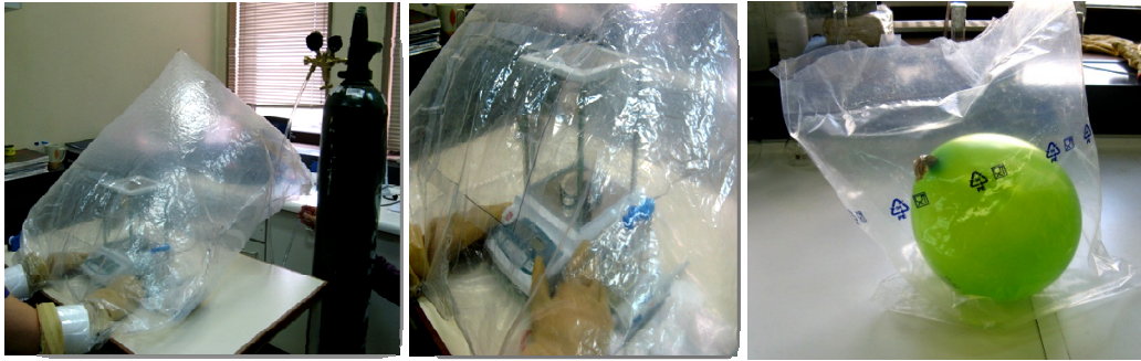
Fig. 7M&M. a. Preparación de la solución de BSH en bolsa de guantes para anaerobiosis purgada previamente con gas inerte ( N_2 ); b. Detalle de la foto a. donde se observa la manipulación de los elementos necesarios en la elaboración de la solución; c. Una vez utilizado el polvo de BSH, el mismo se conserva en una atmósfera inerte con N_2 .
