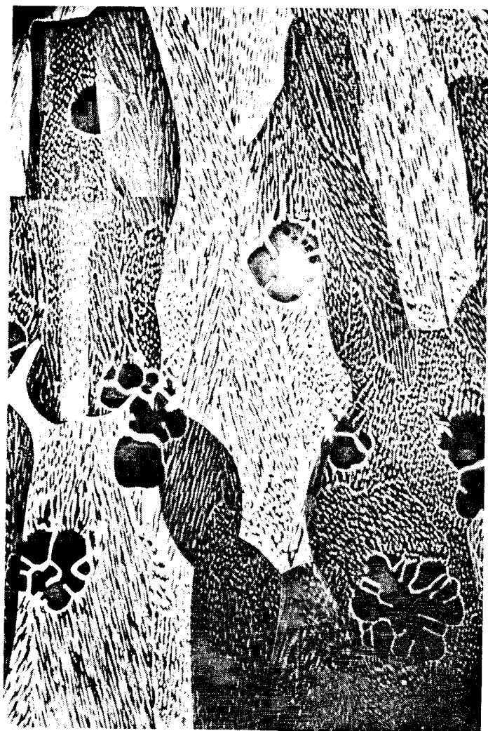
Al 0,1% Cu - Pulido y ataque con Disa-Electropol. 300X Premio Lutz Ferrando 1970
