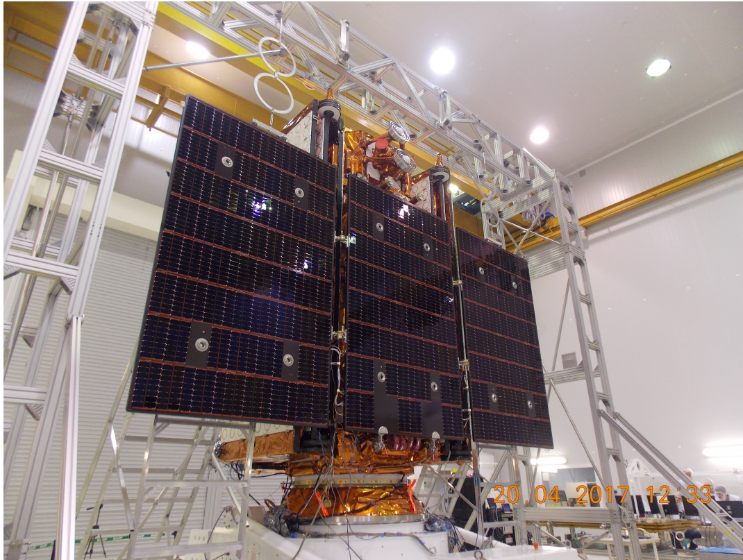
FIGURA 2.1: Satélite SAOCOM 1a con los paneles solares desplegados.
