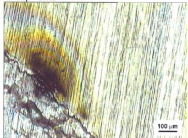
MO - Aumento: 5x – Corrosión en rendijas (zona ocluida del lado inferior izquierdo)
