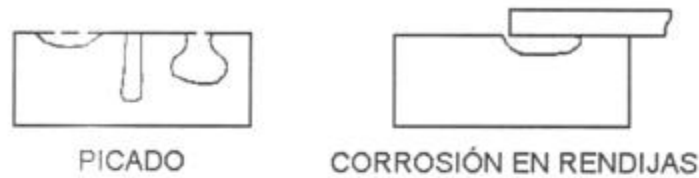
Figura 7: Esquema de los procesos de picado y corrosión en rendijas [22].
