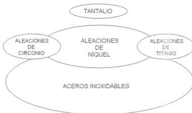
Figura 2: Jerarquía de las aleaciones resistentes a la corrosión [20].
