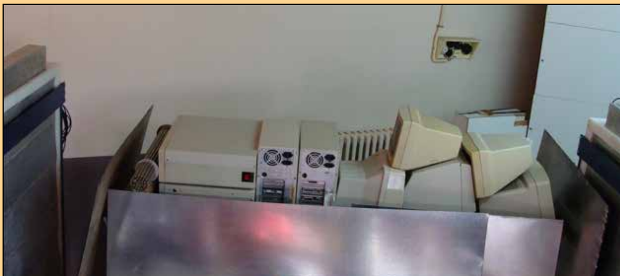
Figura 16. Configuración experimental de contenedor simulado, alineado con haz de neutrones del acelerador incidente desde la derecha. Paredes de 3 mm de acero en ambos extremos. Elemento combustible visible a la izquierda.
