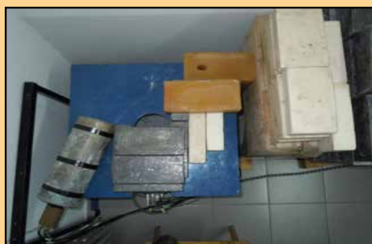
Figura 3. Configuración experimental con la fuente de Am – Be.
