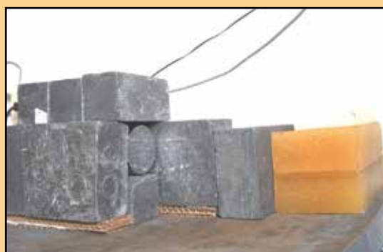
Figura 2. Configuración experimental con la fuente de ^{252}\text{Cf} .
