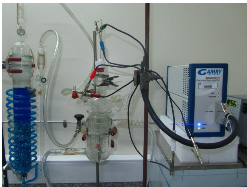
Figura 2.5 - Equipo experimental: Celda de vidrio de tres electrodos con camisa calefactora, termostato, columna purificadora de nitrógeno y potenciostato.
