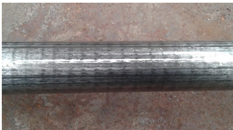
Figura 47. Bulging en tubo de Zircaloy 4 trefilado.
