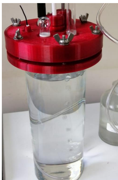
Figura 2.8 Celda 2 con nuevo diseño de tapa fabricada por impresión 3D
