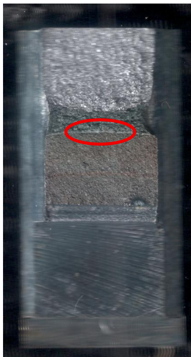
Figura 2.19 Zona de la superficie de fractura en la que se tomaron las fractografías
