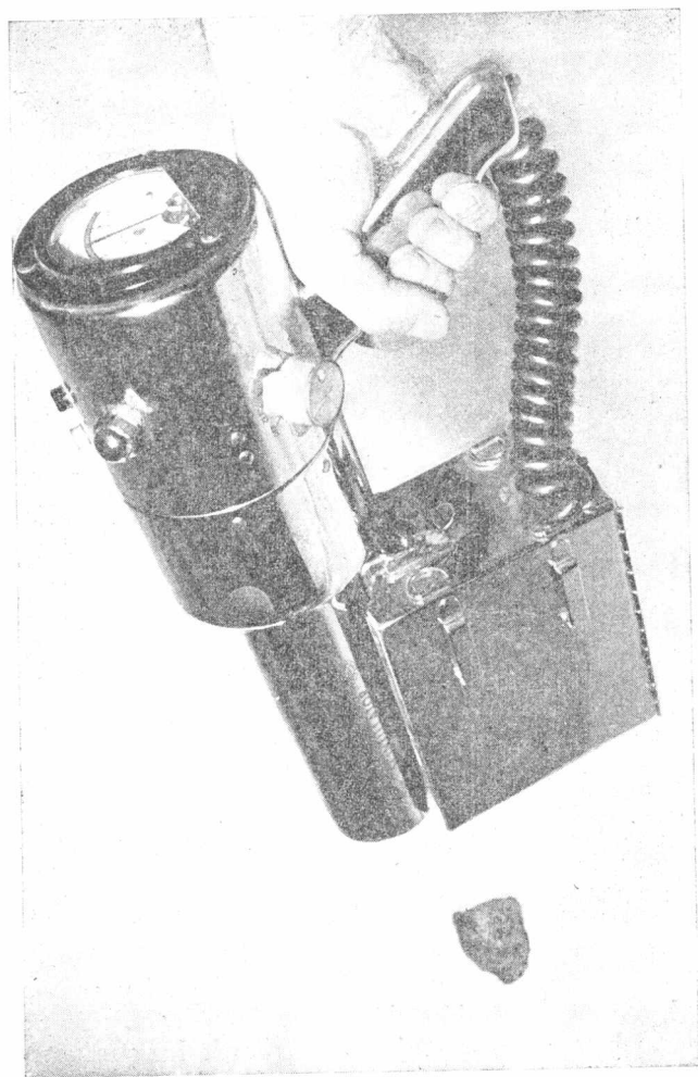
Fig. 2.— Utilización de un detector de centelleo ("scintilómetro") para comprobar la radioactividad de un mineral.
