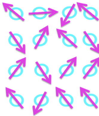
Figura 1.2. Representación esquemática de la distribución de momentos magnéticos atómicos en un material paramagnético.
