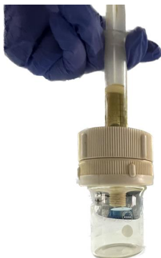
Figura 2.6. Inyección de la solución de los precursores en las membranas usando un portafiltros y un vaso de precipitado.
