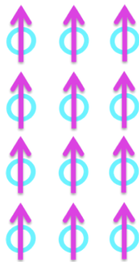
Figura 1.5. Representación esquemática del ordenamiento de los momentos magnéticos en un material ferromagnético.
