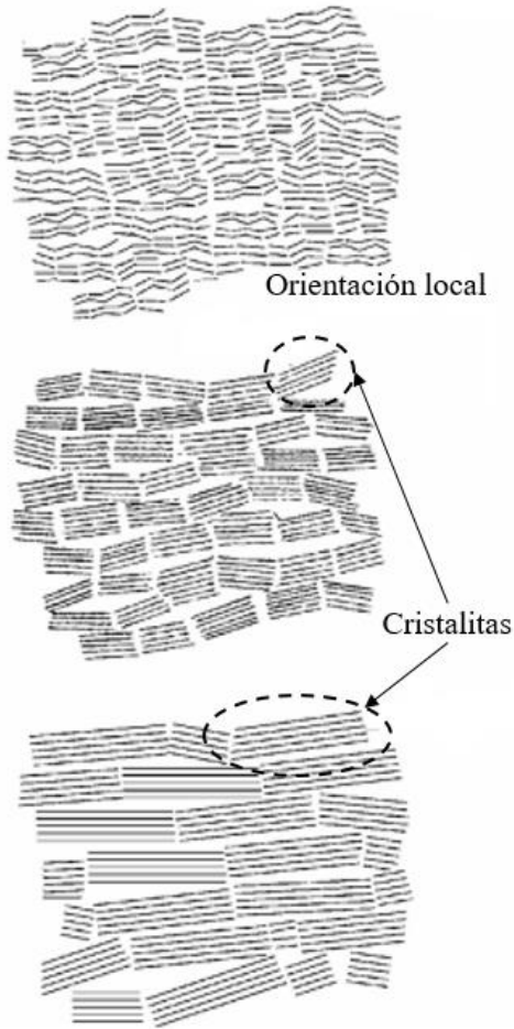
Figura 1.4. Modelos estructurales para carbones grafitizables y no grafitizables al aumentar la temperatura del tratamiento térmico. Adaptación de [3].
